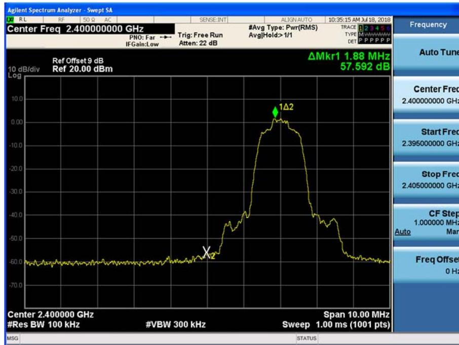
Test Plots without hopping ( $\pi/4$ DQPSK)
