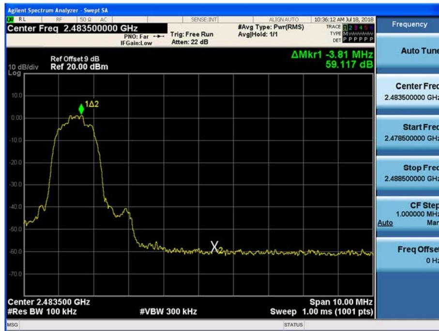
Test Plots without hopping ( $\pi/4$ DQPSK)
