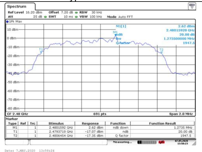
Modulation type: \pi/4 DQPSK 2480MHz
