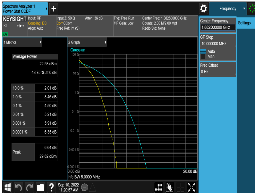
Plot 7-316. PAR Plot (NR Band n25/2 - 5.0MHz DFT-s-OFDM BPSK - Full RB - ANT A)
