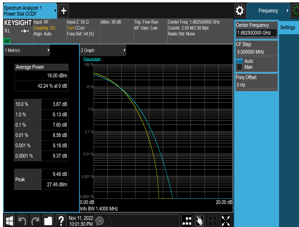
Plot 7-297. PAR Plot (LTE Band 25/2 - 1.4MHz 256-QAM - Full RB - ANT F)
