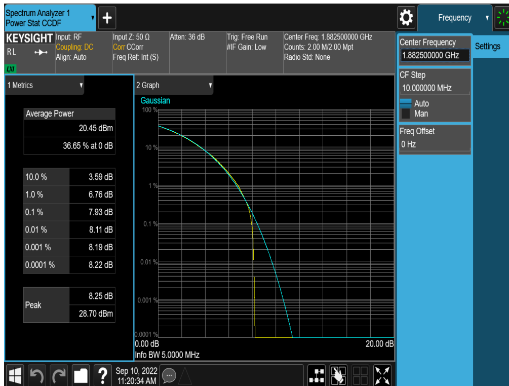
Plot 7-317. PAR Plot (NR Band n25/2 - 5.0MHz CP-OFDM QPSK - Full RB - ANT A)
