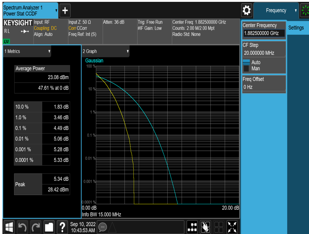
Plot 7-310. PAR Plot (NR Band n25/2 - 15.0MHz DFT-s-OFDM BPSK - Full RB - ANT A)
