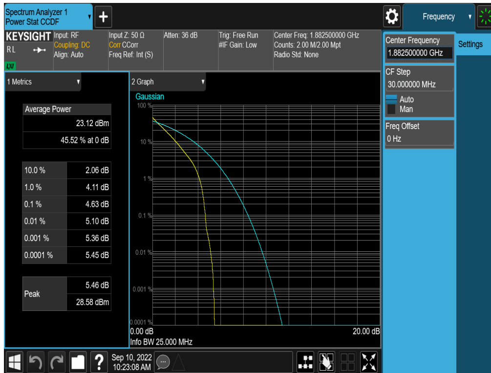
Plot 7-304. PAR Plot (NR Band n25/2 - 25.0MHz DFT-s-OFDM BPSK - Full RB - ANT A)
