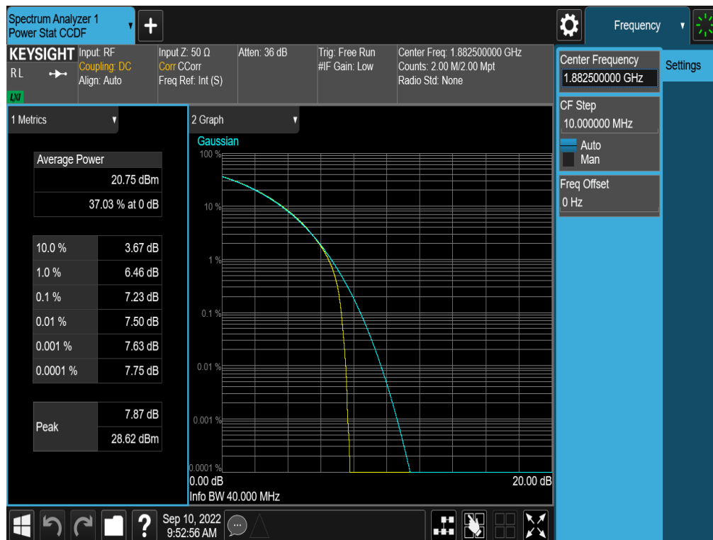
Plot 7-299. PAR Plot (NR Band n25/2 - 40.0MHz CP-OFDM QPSK - Full RB - ANT A)
