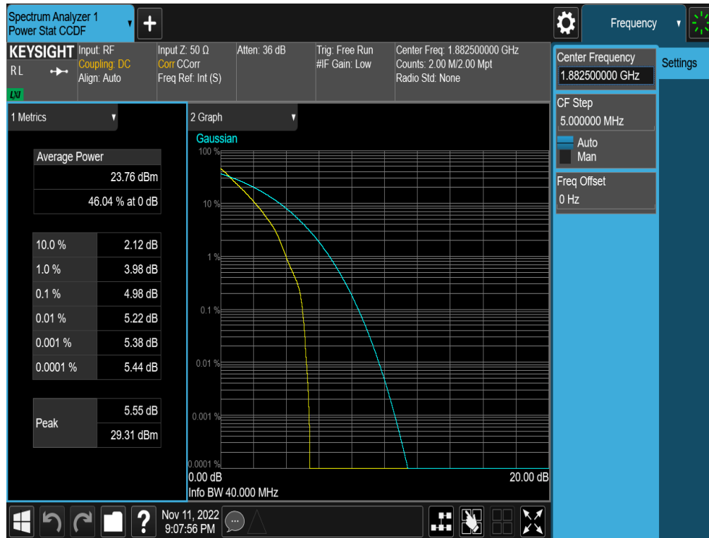
Plot 7-319. PAR Plot (NR Band n25/2 - 40.0MHz DFT-s-OFDM BPSK - Full RB - ANT F)
