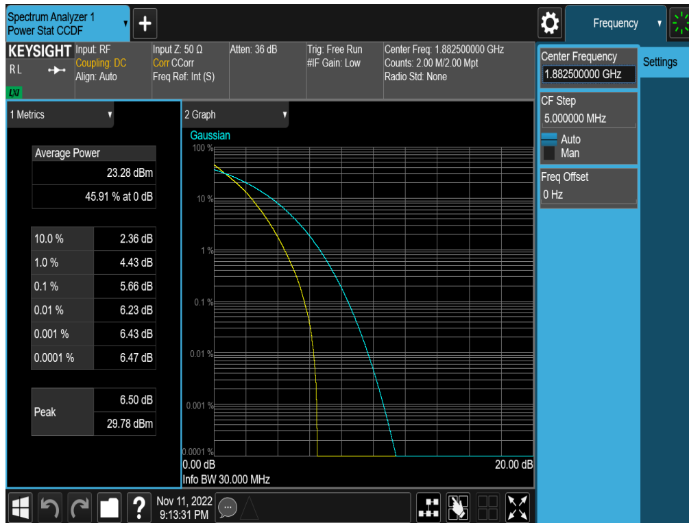
Plot 7-323. PAR Plot (NR Band n25/2 - 30.0MHz CP-OFDM QPSK - Full RB - ANT F)
