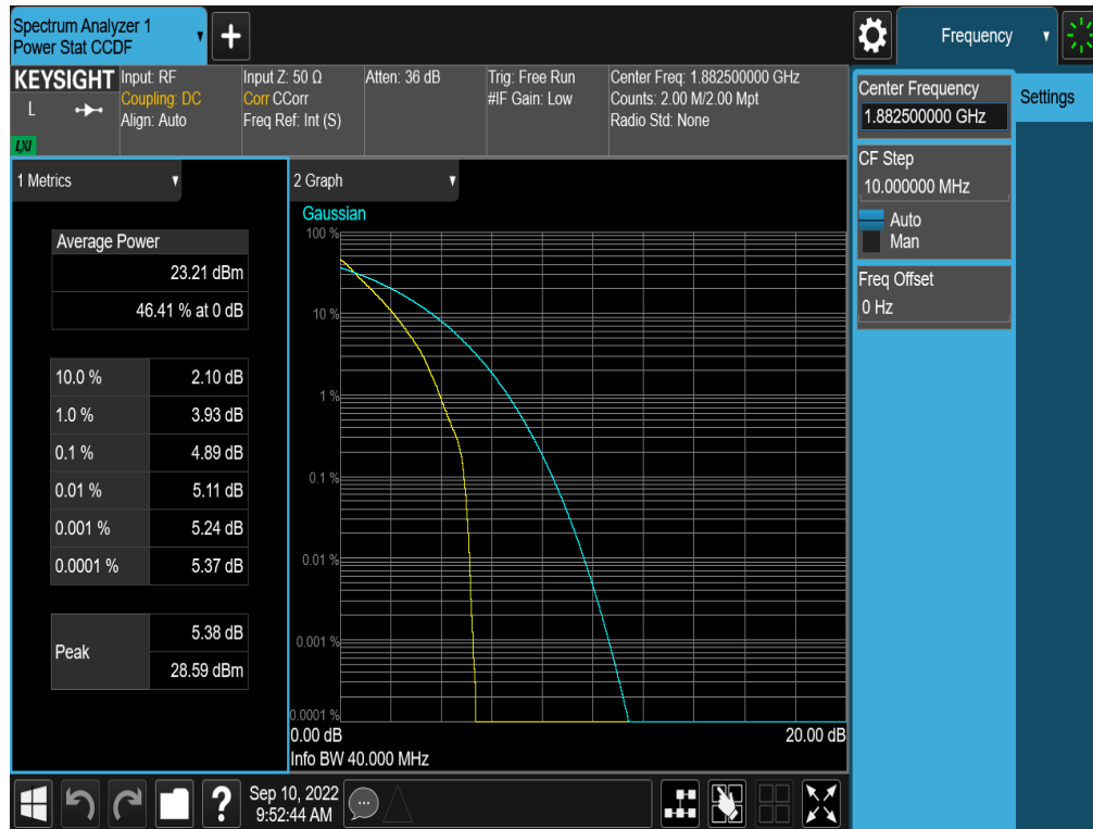
Plot 7-298. PAR Plot (NR Band n25/2 - 40.0MHz DFT-s-OFDM BPSK - Full RB - ANT A)
