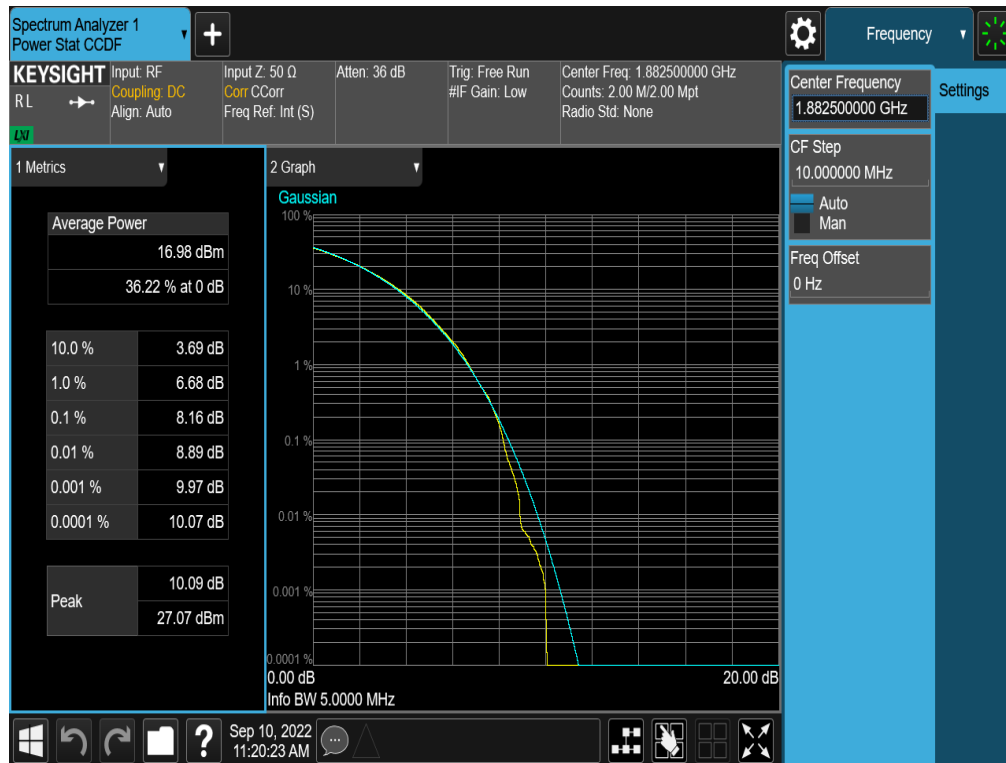
Plot 7-318. PAR Plot (NR Band n25/2 - 5.0MHz CP-OFDM 256-QAM - Full RB - ANT A)
