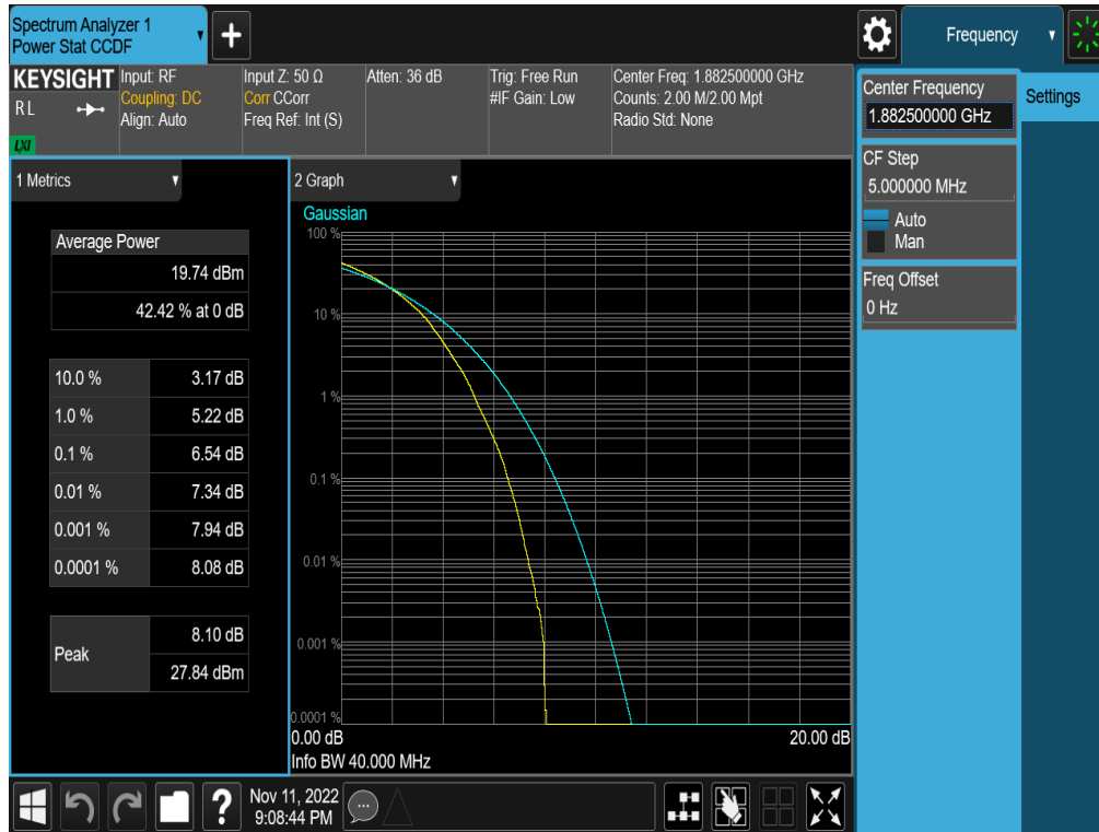
Plot 7-321. PAR Plot (NR Band n25/2 - 40.0MHz CP-OFDM 256-QAM - Full RB - ANT F)
