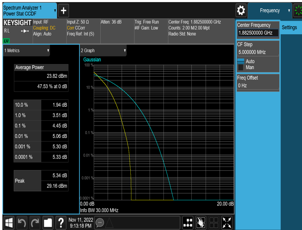
Plot 7-322. PAR Plot (NR Band n25/2 - 30.0MHz DFT-s-OFDM BPSK - Full RB - ANT F)
