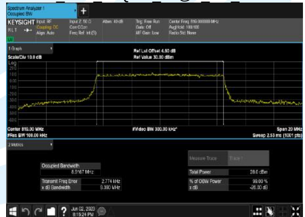
B26 10M 16QAM 50@0 CH 26740
