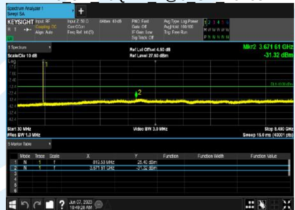
B26 3M 16QAM 1@0 CH 26705
