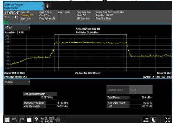
B26 10M 16QAM 50@0 CH 26740
