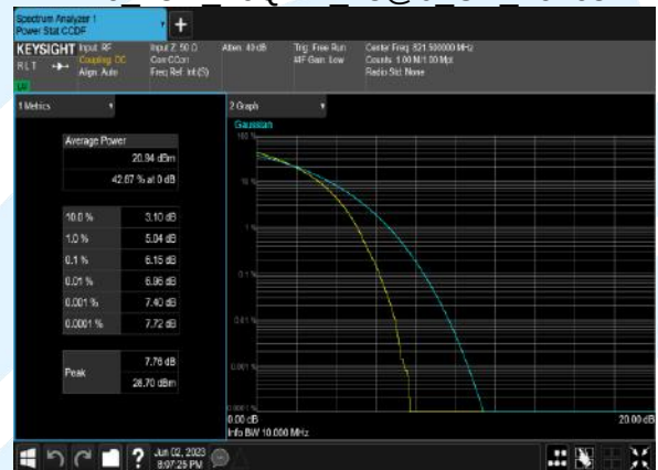
B26 10M 16QAM 50@0 CH 26740
