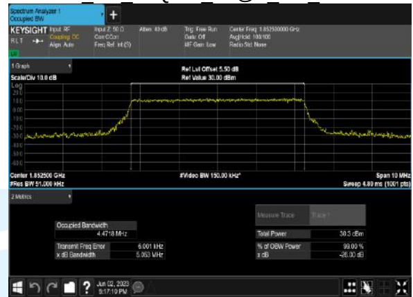
B25 5M 16QAM 25@0 CH 26365
