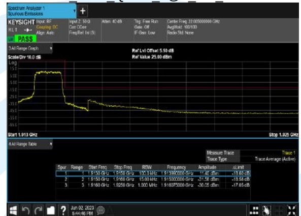
B25 1.4M 16QAM 6@0 CH 26683
