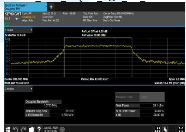
B26 1.4M 16QAM 6@0 CH 26740
