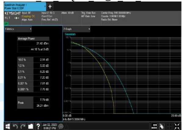
B26 5M 16QAM 25@0 CH 26740
