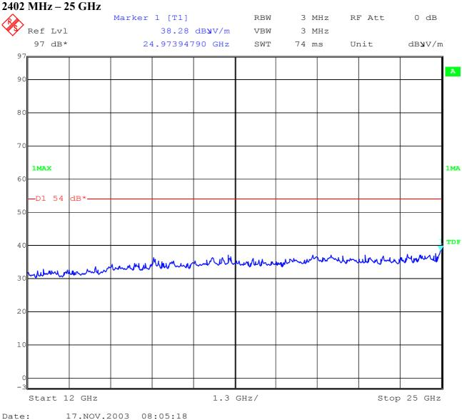
f < 1 GHz: RBW/VBW: 100 kHz  $f \ge 1 \text{ GHz}$ : RBW/VBW: 1 MHz
