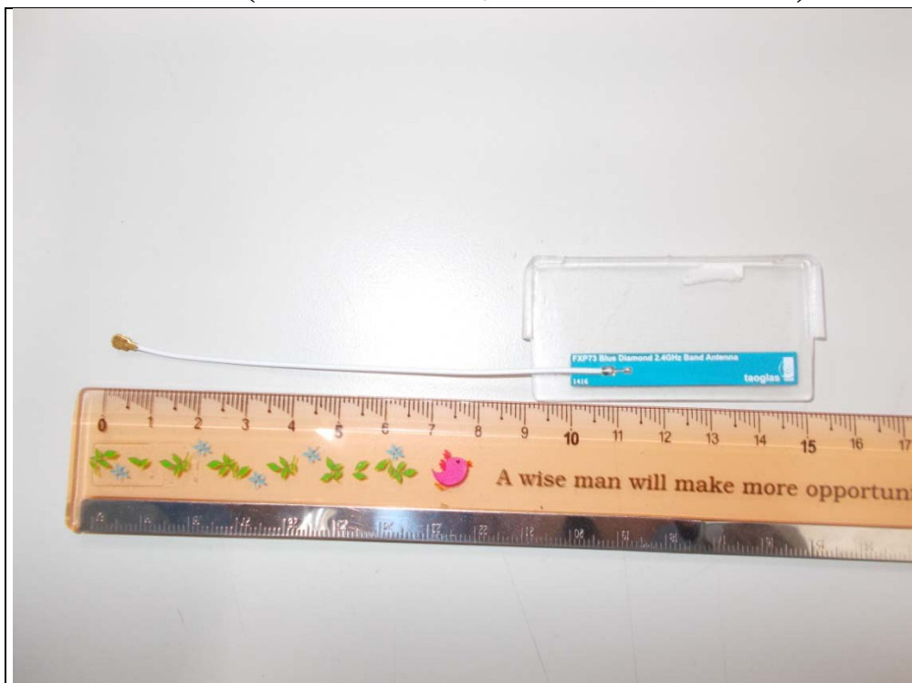
Antenna 2 (Brand: TAOGLAS ; Model: FXP73.07.0100A)
