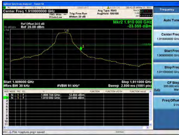
Band2 / 5MHz / Low CH / QPSK / 1 RB
