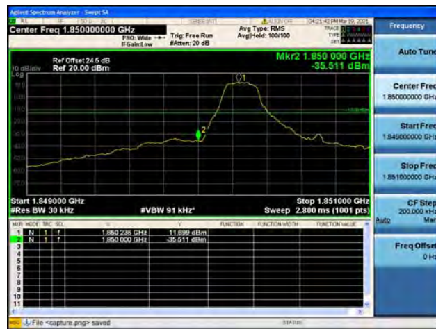
Band2 / 1.4MHz / High CH / QPSK / 1 RB
