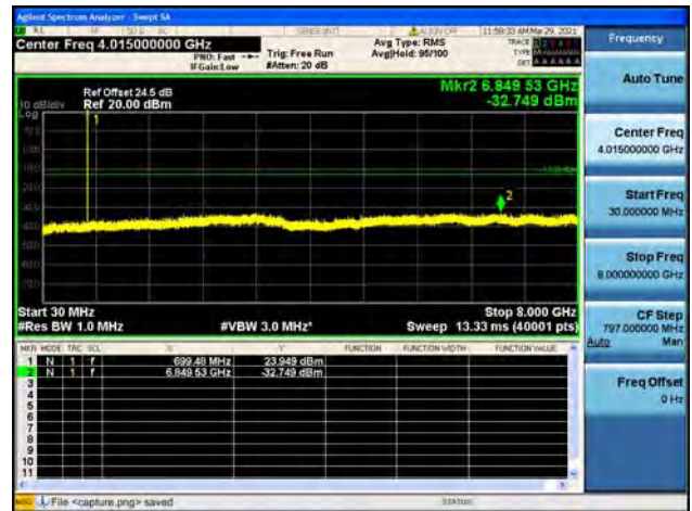
Band12 / 5MHz / Mid CH / QPSK
