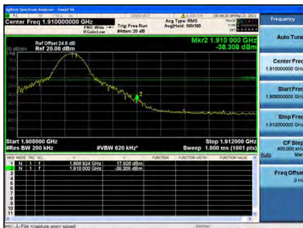
Band2 / 20MHz / High CH / QPSK / 1 RB
