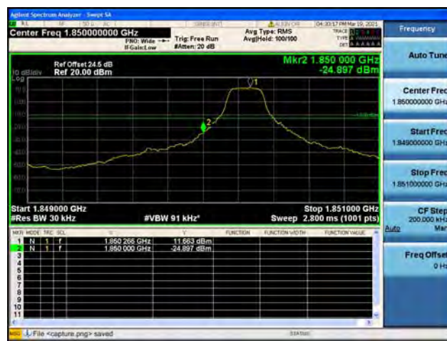
Band2 / 3MHz / Low CH / QPSK / 1 RB
