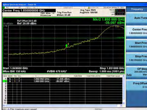
Band2 / 15MHz / Low CH / QPSK / 1 RB
