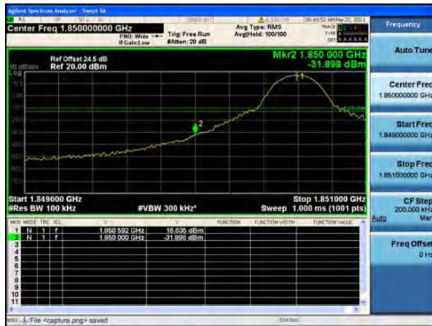
Band2 / 10MHz / High CH / QPSK / 1 RB
