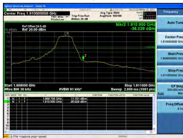
Band2 / 3MHz / Low CH / QPSK / 1 RB
