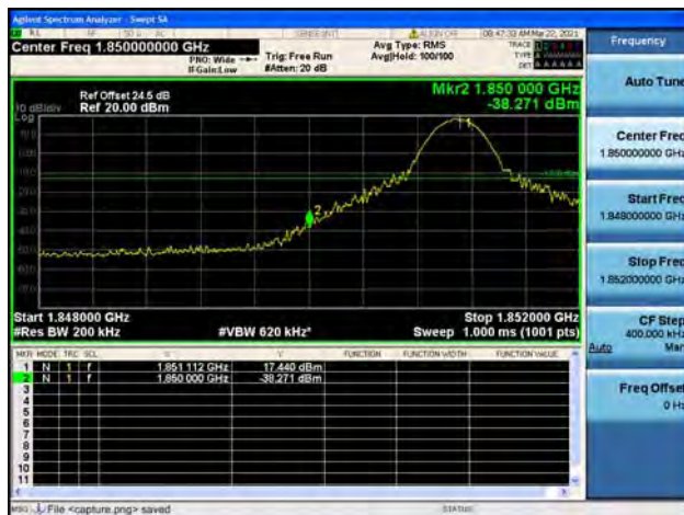
Band2 / 20MHz / High CH / QPSK / 1 RB
