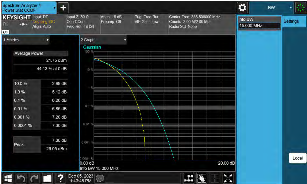
Sub6 n5. PAR Plot (15 M BW_Ch. 167300_64QAM_Full RB_0)
