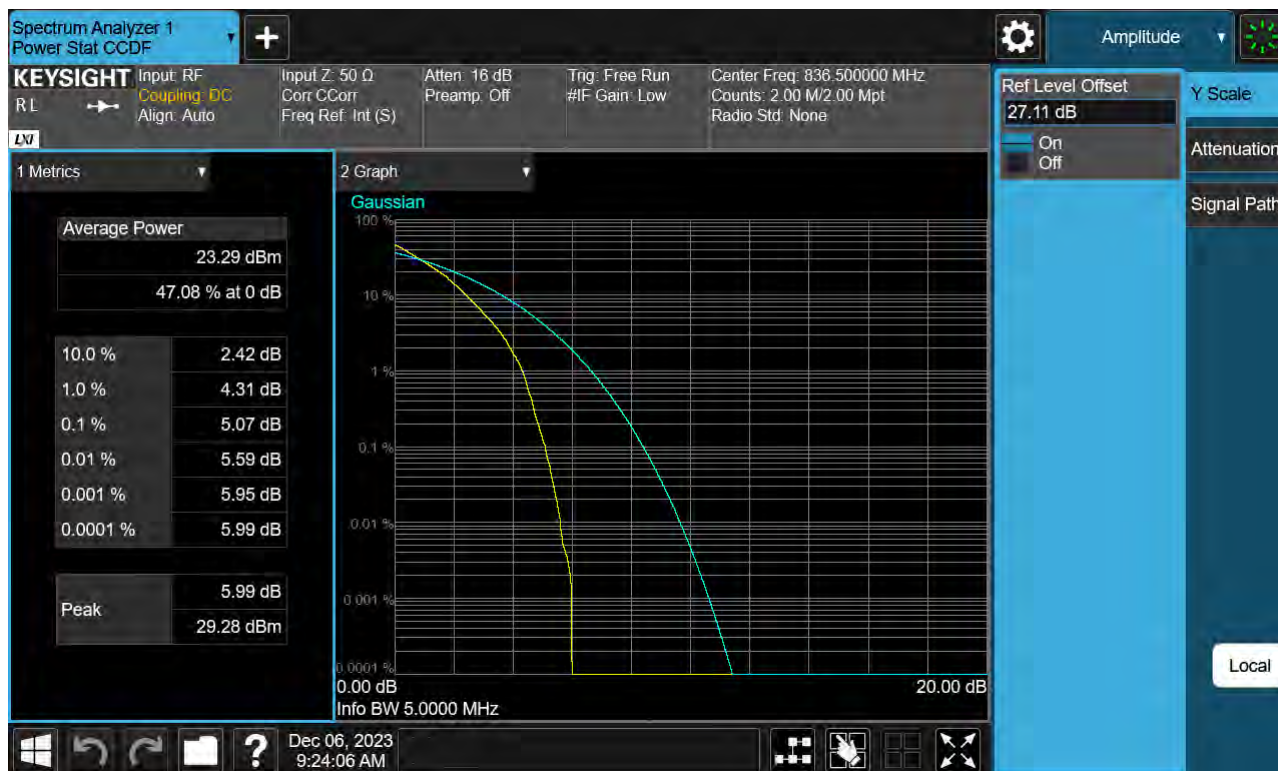
Sub6 n5. PAR Plot (5 M BW_Ch. 167300_QPSK_Full RB _0)
