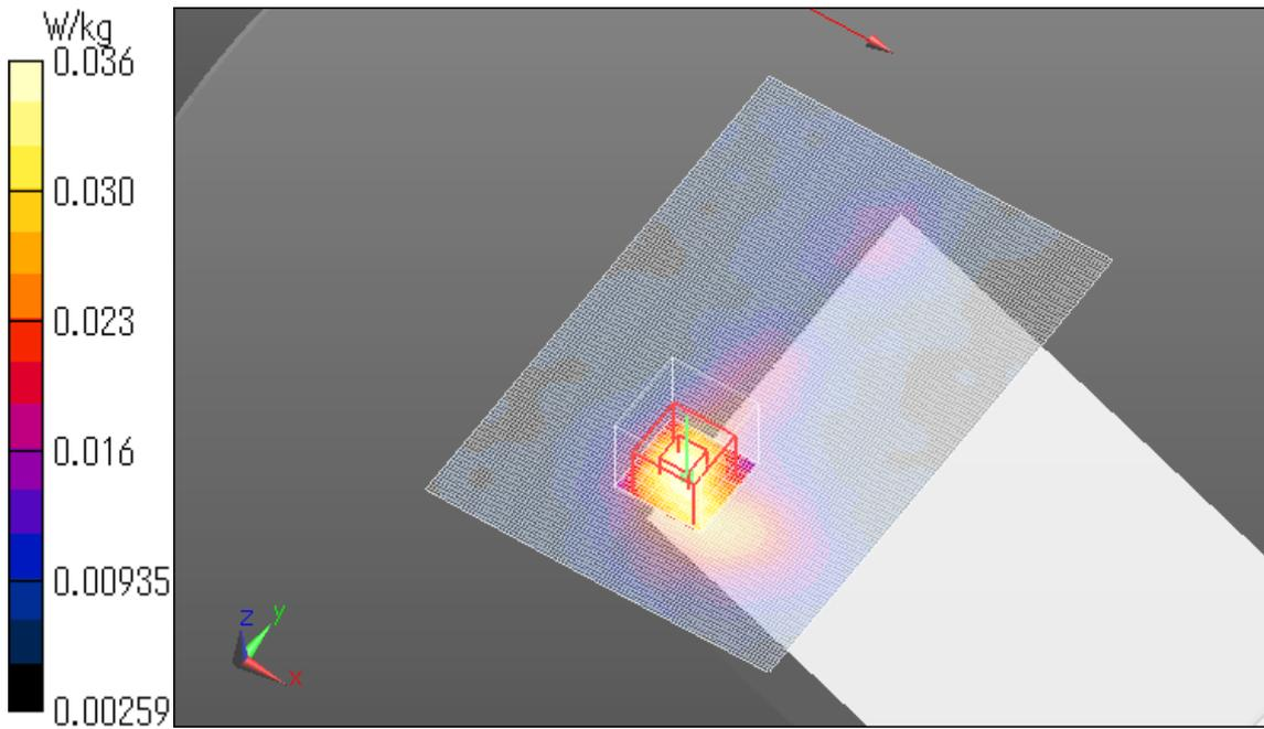
**WLAN 11b 1Mbps Aux Ant Edge1 0mm 2422MHz**
