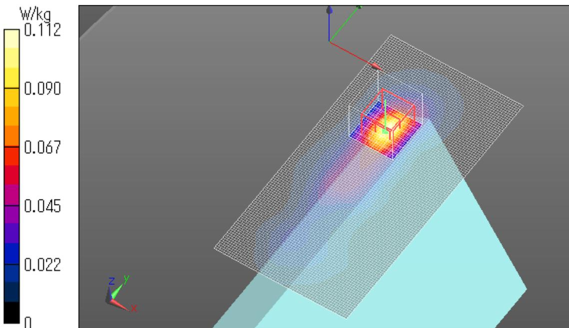
**WLAN 11b 1Mbps Main Ant Position 4 6mm 2422MHz**
