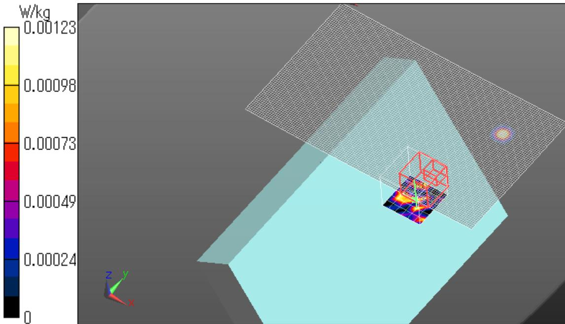
**WLAN 11b 1Mbps Aux Ant Position4 6mm 2422MHz**
