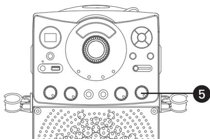
5 Réglez le Commande **VOLUME MICRO (MIC VOLUME)** au niveau souhaité. Le fait de monter ce réglage augmente le volume du micro.
