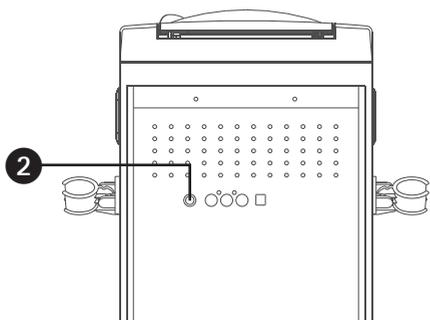
2 Connectez l'appareil audio externe à l'entrée LINE IN située à l'arrière de cet appareil. La connexion avec l'appareil externe permettra au son audio d'être en lecture sur le Singing Machine. La fonction LINE IN est automatiquement sélectionnée une fois que le câble audio est connecté.
