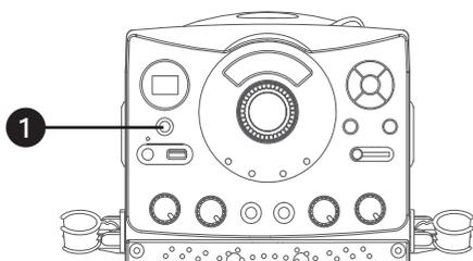
1 Raccordez l'appareil de la manière décrite précédemment. Appuyez sur la touche d'alimentation **MARCHE/ARRÊT (ON/OFF)** pour allumer l'appareil.
