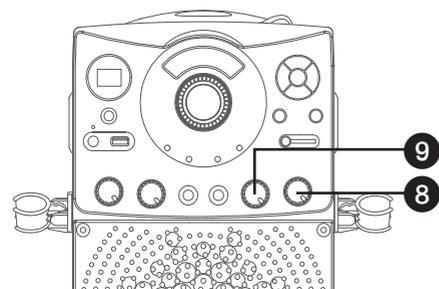
9 Réglez la commande **ÉCHO (ECHO)** pour appliquer un effet d'écho à votre voix. Tourner dans le sens horaire pour augmenter l'effet écho.
