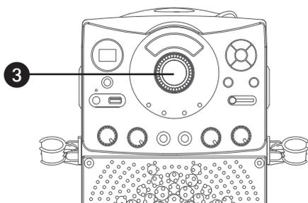
3 Réglez le volume en utilisant la commande de **VOLUME PRINCIPAL (MASTER VOLUME)** de cet appareil ou à partir de la commande de volume de votre dispositif externe.
