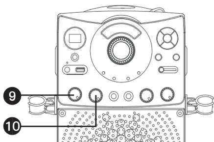
9 L'option **CONTRÔLE AUTOMATIQUE DE LA VOIX** peut être activée en tournant la commande **AVC**. Plus la commande est réglée à un niveau élevé, plus les voix sur l'enregistrement multiplex sont mises en sourdine lorsque le chanteur commence à chanter dans le microphone. Lorsque le chanteur arrête de chanter, les voix enregistrées sur l'enregistrement multiplex reprennent en mode normal.
