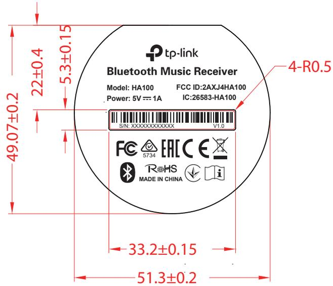
文字和图形由供应商内凹刻字，凹字深度0.2mm，凹字表面抛光处理；
