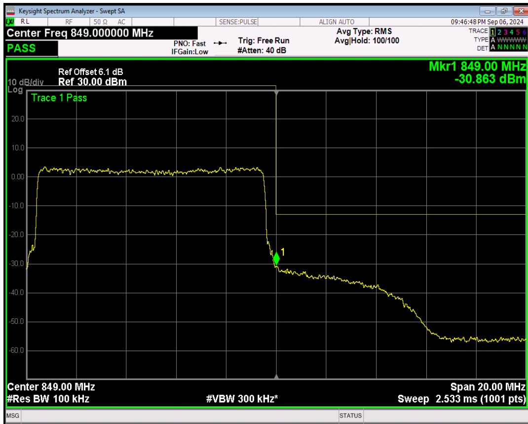
Band26(824-849) QPSK BW=15MHz Channel=26865 RB Size=1 Position=#0
