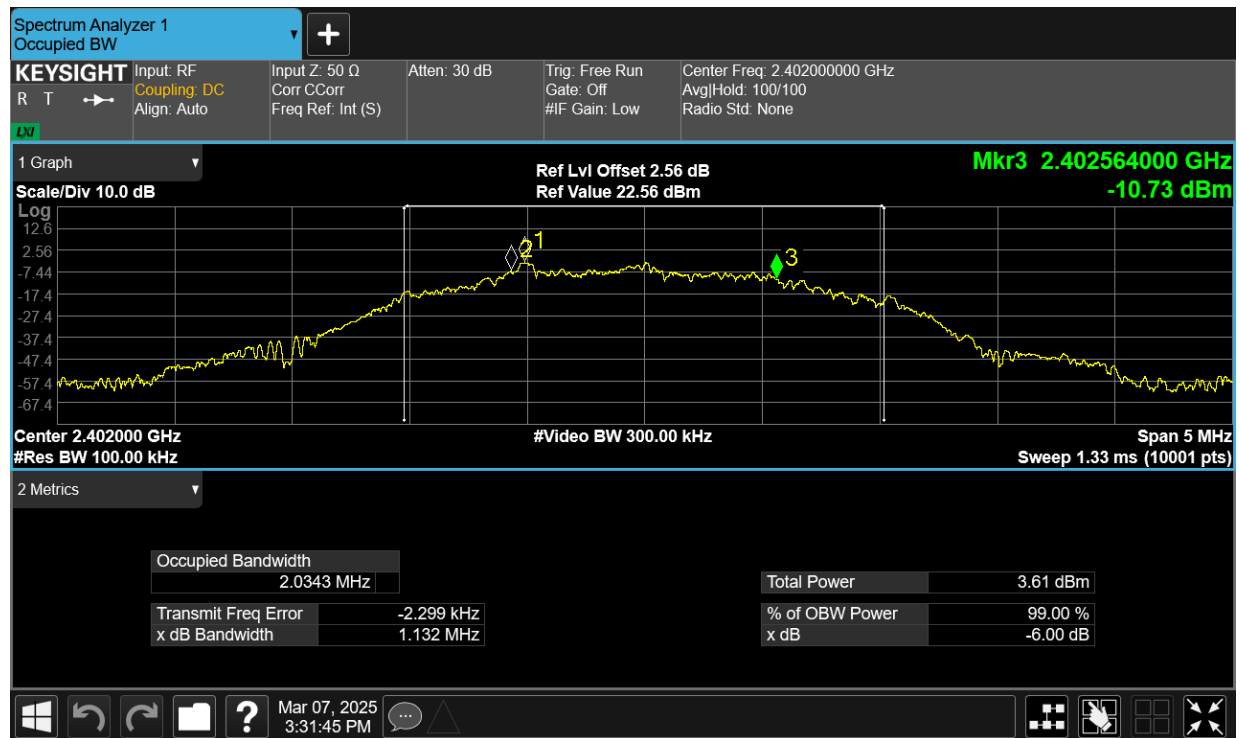
-6dB Bandwidth NVNT BLE 2442MHz Ant1
