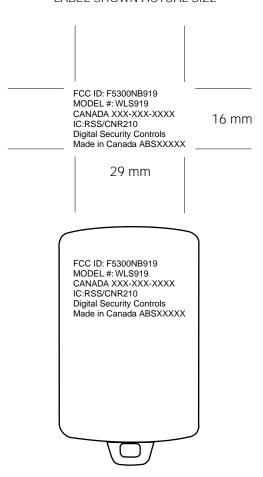
REAR HOUSING OF THE UNIT SHOWING PLACEMENT OF LABEL (ACTUAL SIZE)
