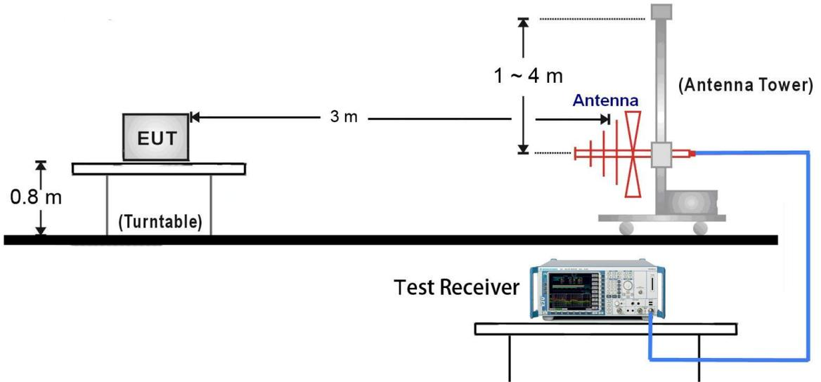
1GHz ~ 25GHz Test Setup:
