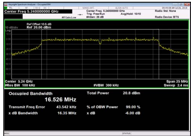
U-NII-1 6dB Bandwidth-802.11ac(20MHz) ,5220MHz
