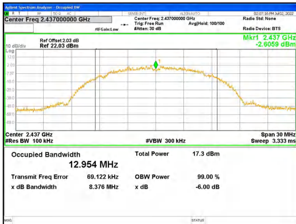
-6dB Bandwidth NVNT b 2462MHz Ant1
