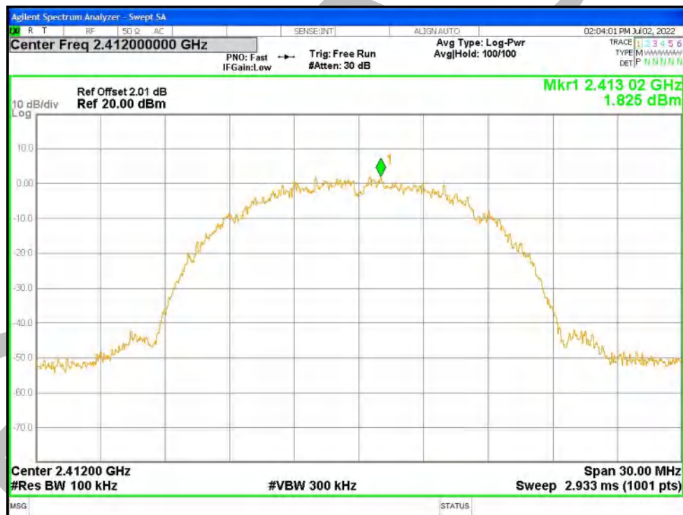
PSD NVNT b 2437MHz Ant1
