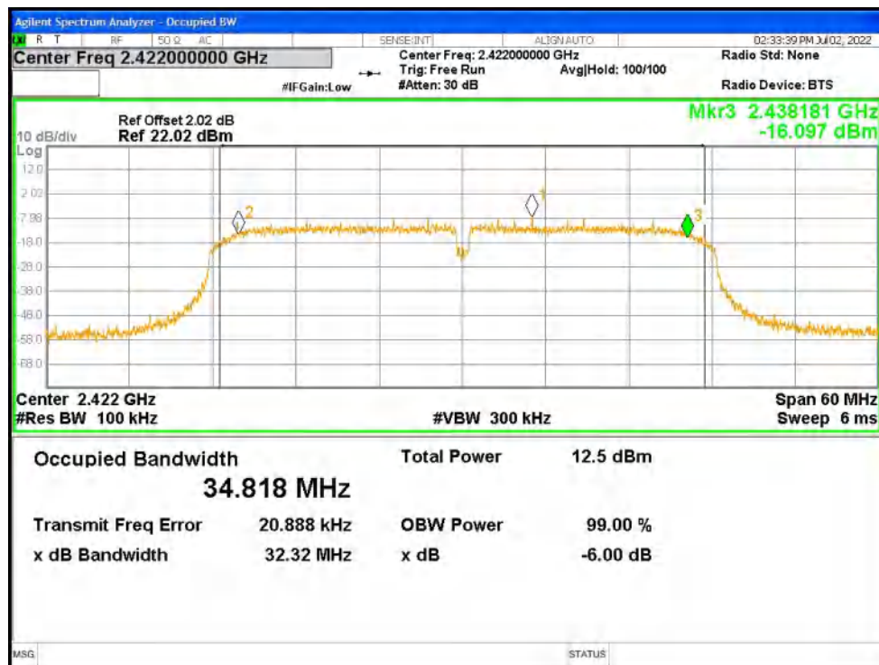
-6dB Bandwidth NVNT n40 2437MHz Ant1
