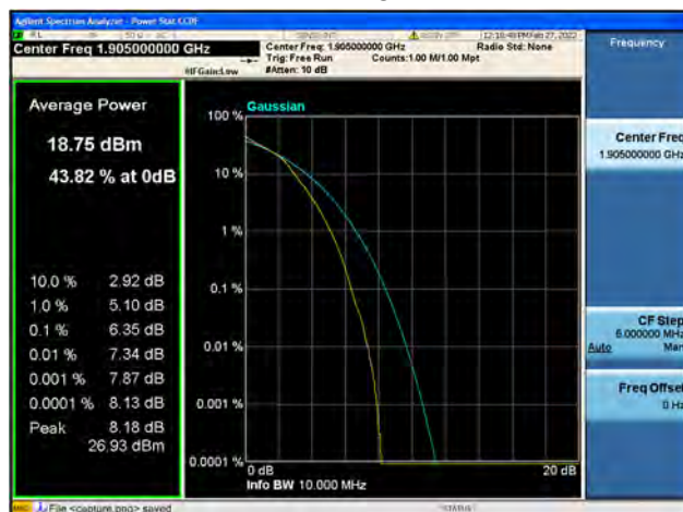
Band2 / 10MHz / High CH / 16QAM
