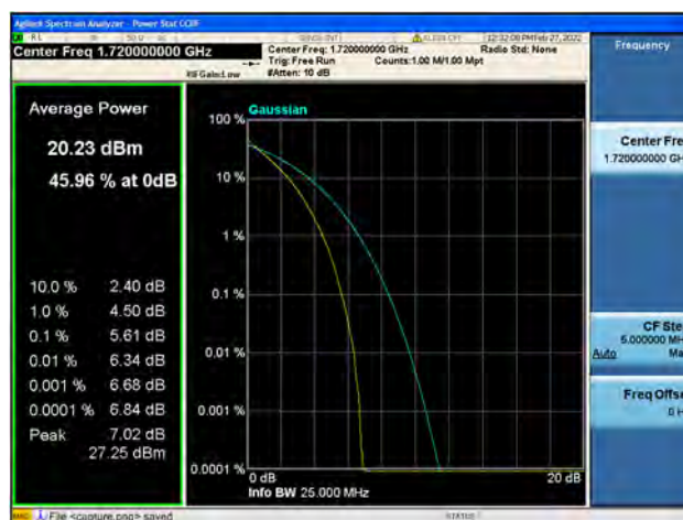
Band4 / 20MHz / Low CH / 64QAM
