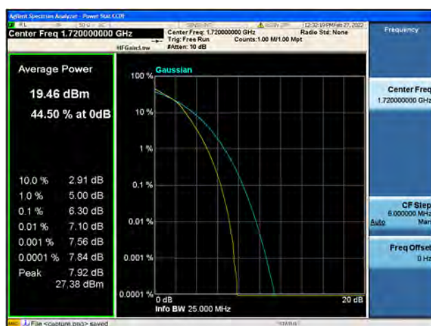
Band4 / 20MHz / Low CH / 16QAM
