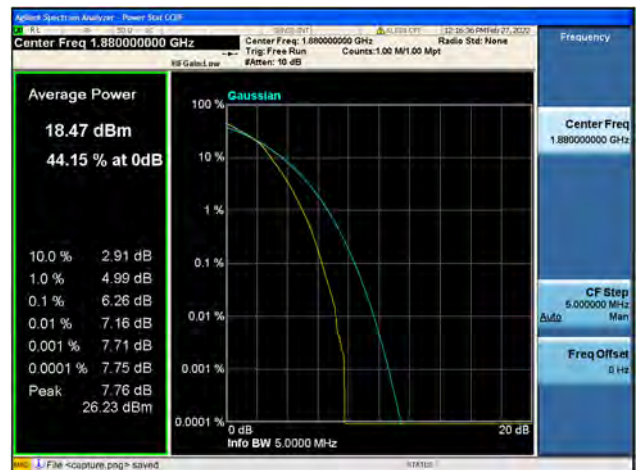
Band2 / 5MHz / Mid CH / 64QAM
