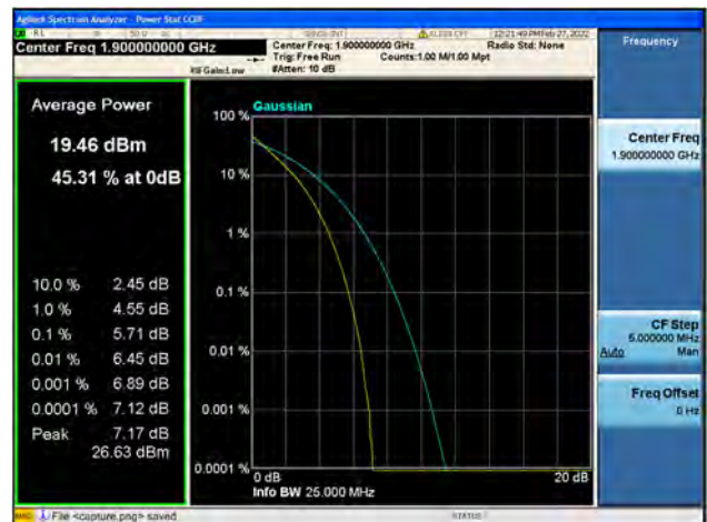
Band2 / 20MHz / High CH / 64QAM
