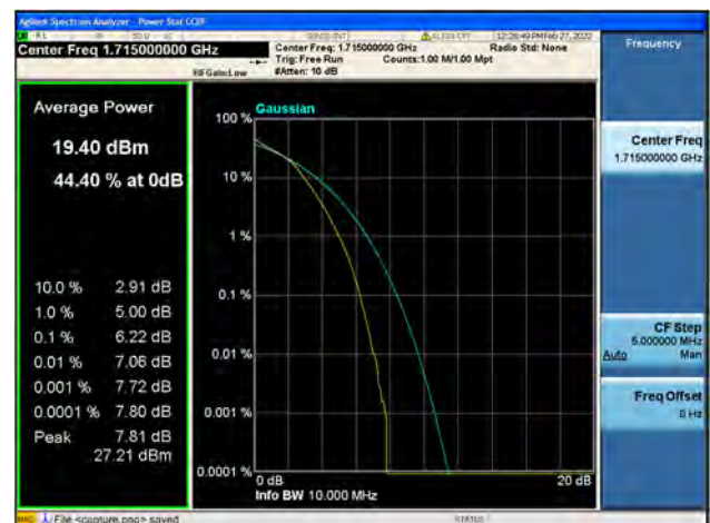
Band4 / 10MHz / Low CH / 64QAM
