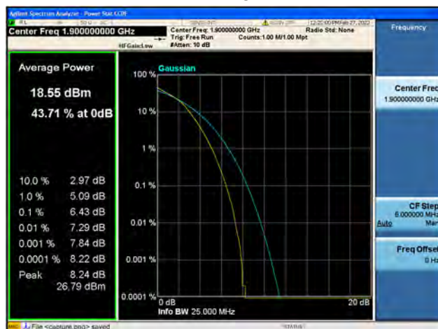
Band2 / 20MHz / High CH / 16QAM
