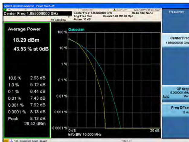
Band2 / 10MHz / Low CH / 16QAM
