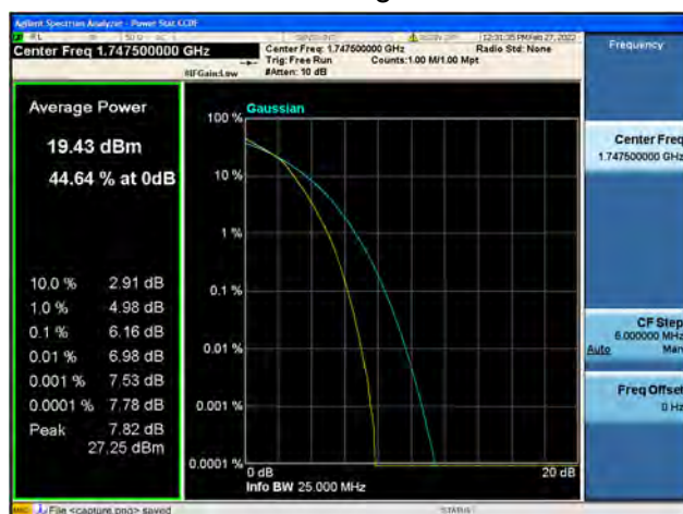
Band4 / 20MHz / Low CH / 16QAM
