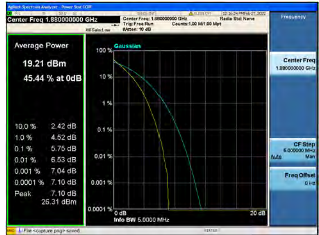
Band2 / 5MHz / Mid CH / 64QAM
