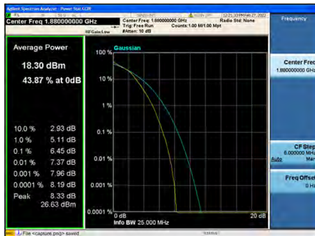
Band2 / 20MHz / High CH / 16QAM
