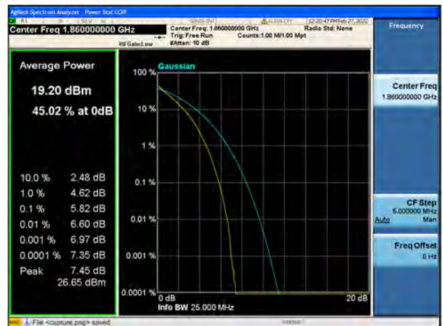
Band2 / 20MHz / Low CH / 64QAM
