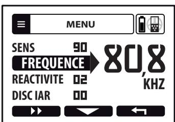
Décalez la fréquence afin d'éviter d'être parasité par un détecteur voisin ou des perturbations électromagnétiques.
