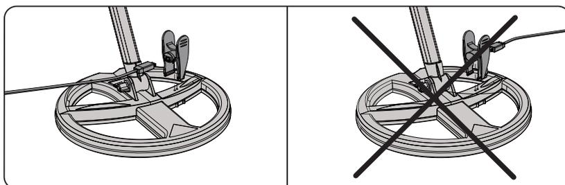
La sortie de la pince doit être orientée vers le centre du disque.
