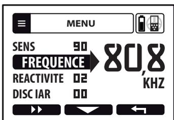
Sélectionnez la Fréquence avec
