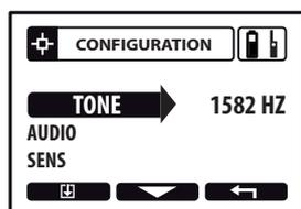
Modifie la tonalité du signal audio émis par la télécommande, des tonalités basses à aigu de 100 à 1582 Hz.
