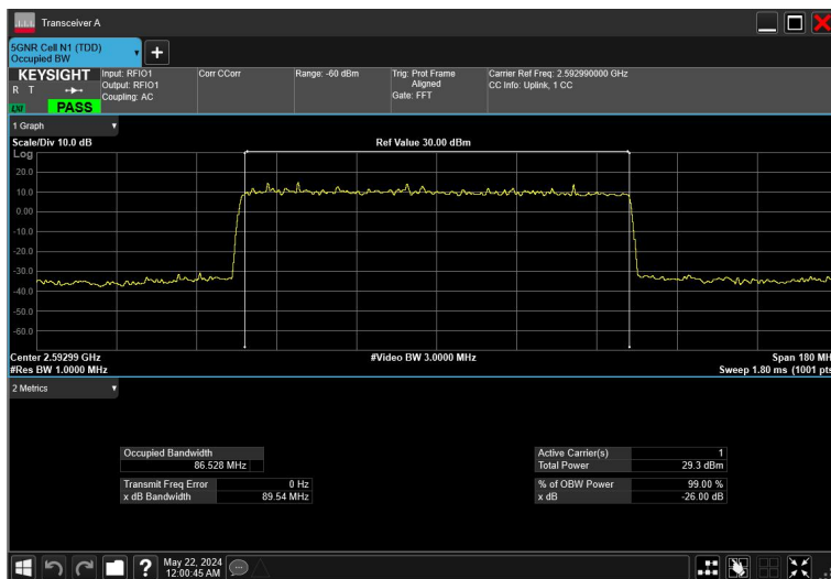
90MHz_30kHz_2592.99MHz_DFT-s-OFDM \pi/2 BPSK_RB243@0
