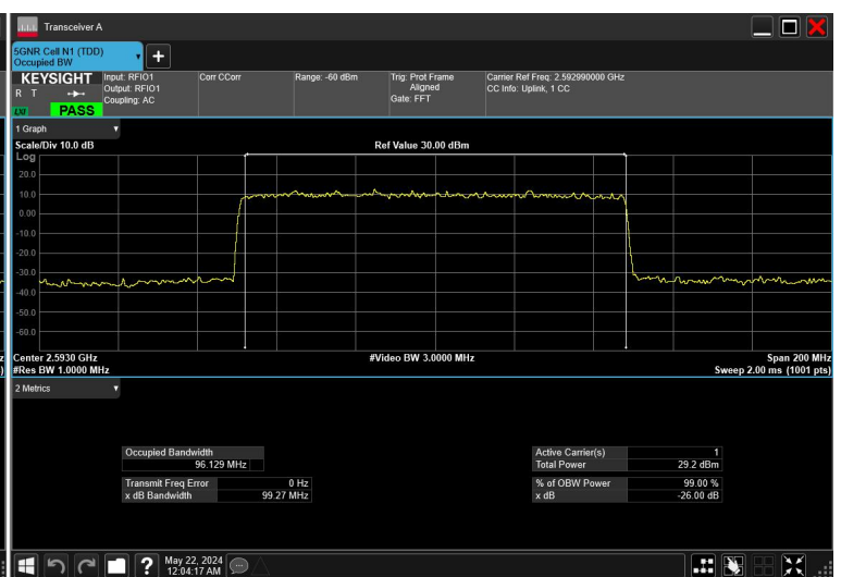
100MHz_30kHz_2592.99MHz_DFT-s-OFDM \pi/2 BPSK_RB270@0
