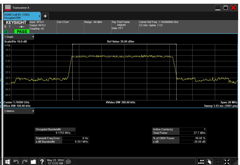
10MHz_15kHz_1745MHz_DFT-s-OFDM \pi/2 BPSK_RB50@0
