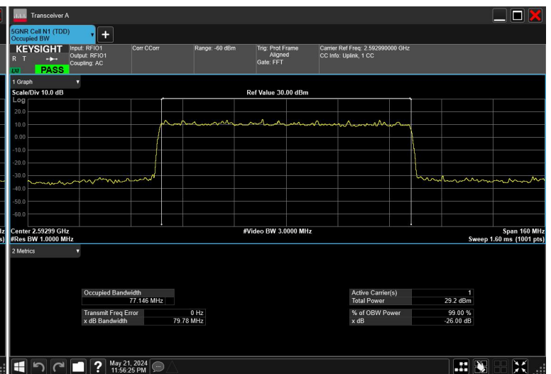
80MHz_30kHz_2592.99MHz_DFT-s-OFDM \pi/2 BPSK_RB216@0
