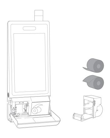
同时按下左右按钮,打开下翻盖面板。 放入热敏打印纸,并拉出一段于出纸口外。
