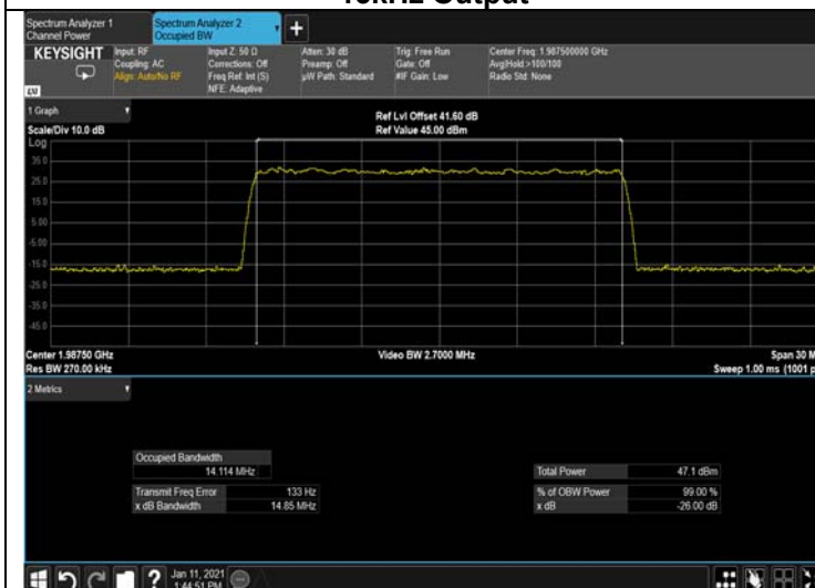
Figure 303: 256QAM 15MHz B.W.; 1987.5MHz, 15kHz Output
