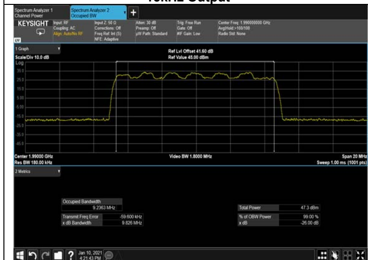
Figure 261: 16QAM 10MHz B.W.; 1990.0MHz, 15kHz Output
