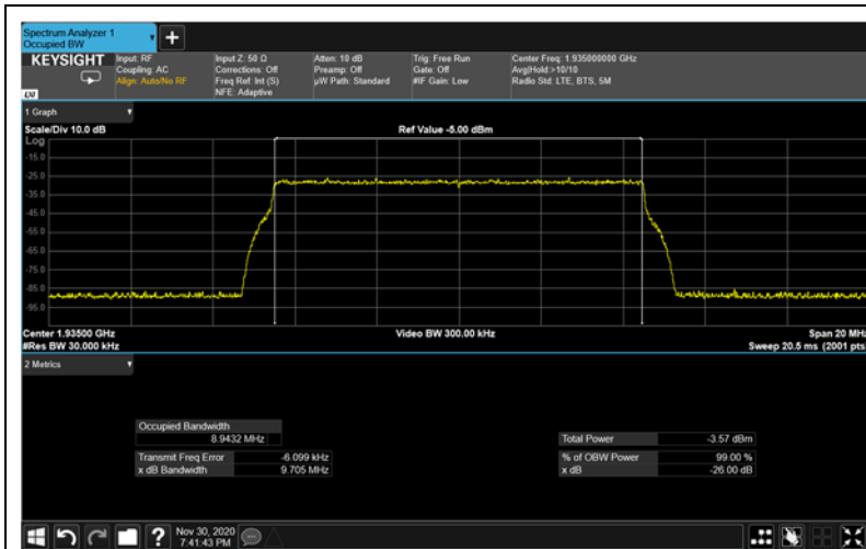
Figure 338: 64QAM 10MHz B.W.; 1935MHz Input – 4G
