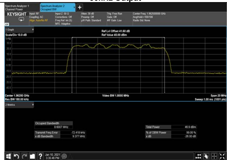
Figure 260: 16QAM 10MHz B.W.; 1962.5MHz, 30kHz Output
