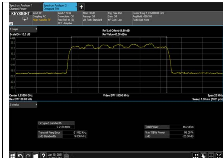
Figure 257: 16QAM 10MHz B.W.; 1935.0MHz, 15kHz Output
