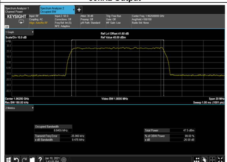
Figure 296: 256QAM 10MHz B.W.; 1962.5MHz, 30kHz Output
