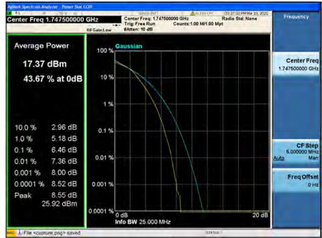
Band4 / 20MHz / Low CH / QPSK
