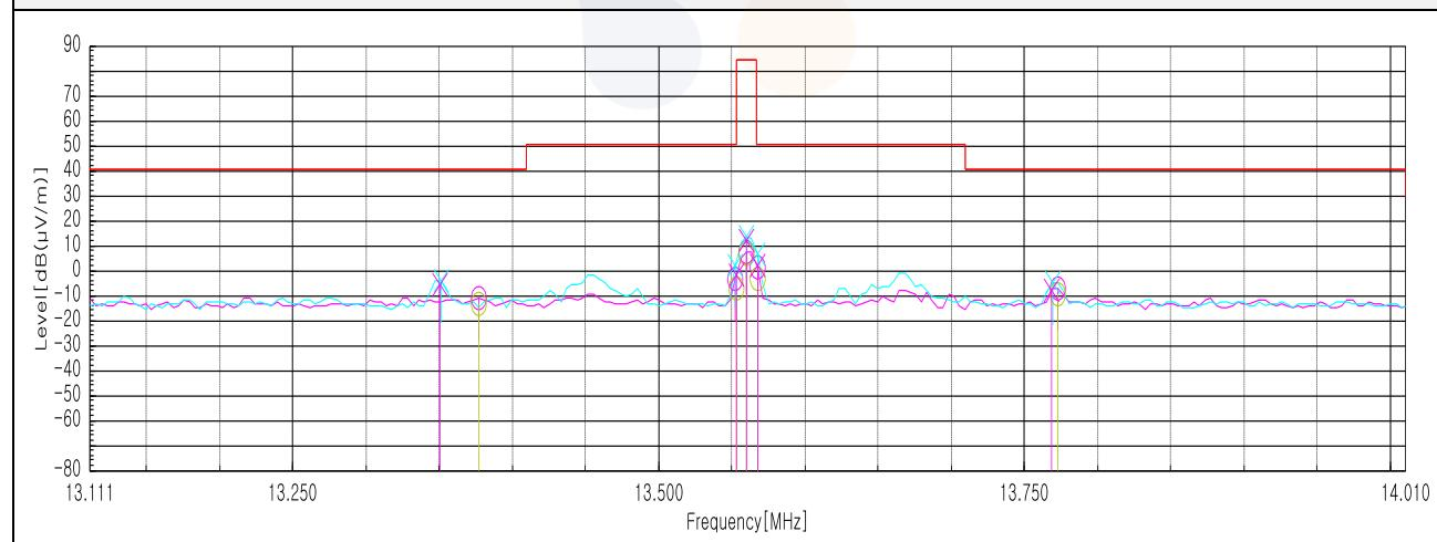
**Test results (9 kHz to 30 MHz)****15.225 (d) 0.009-30 MHz**
