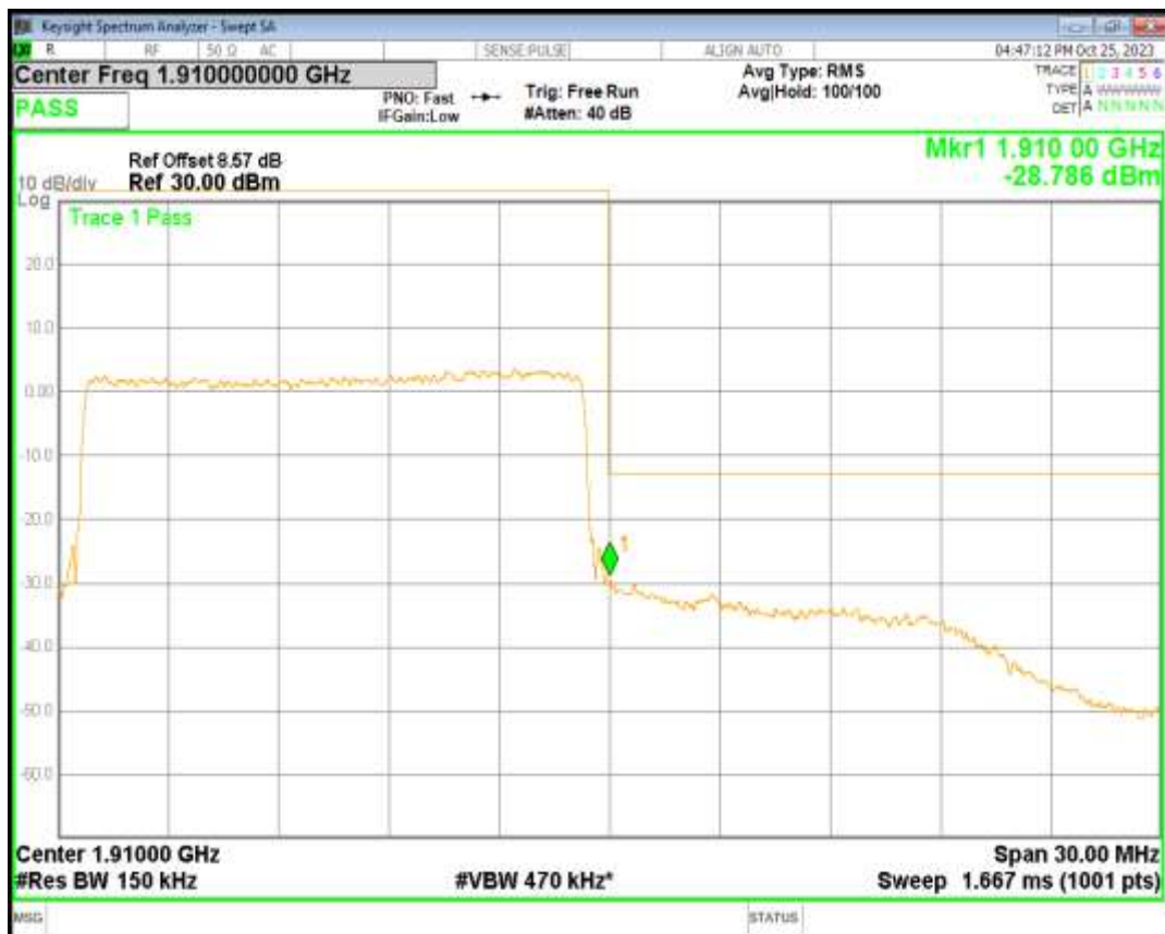
Band2 16QAM BW=20MHz Channel=18700 RB Size=100 Position=#0
