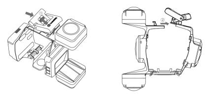
**步骤二:**如下图所示,将相机支架连接扣对应锁合至无人机底部。
