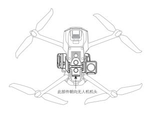
**步骤三:** 锁合锁栓,请务必确保锁栓的黄色标识显示不可见。
