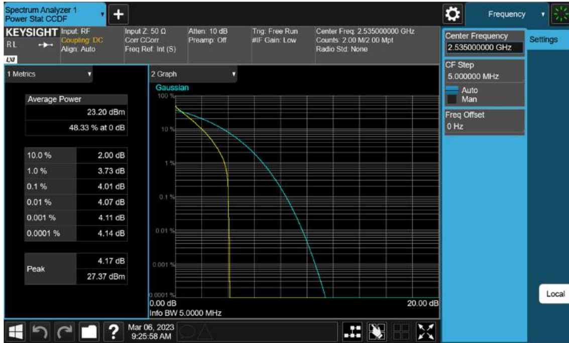
Sub6 n7. PAR Plot (5 M BW_Ch.507000_ BPSK)
