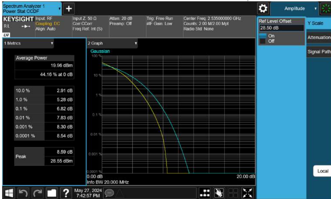
Sub6 n7. PAR Plot (20 M BW_Ch.507000_256QAM)
