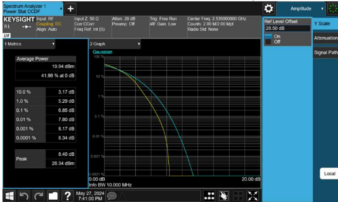
Sub6 n7. PAR Plot (10 M BW_Ch.507000_256QAM)
