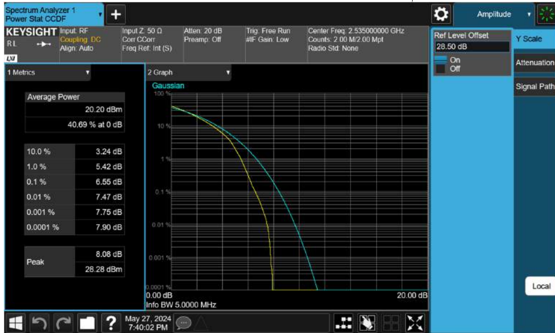
Sub6 n7. PAR Plot (5 M BW_Ch.507000_256QAM)
