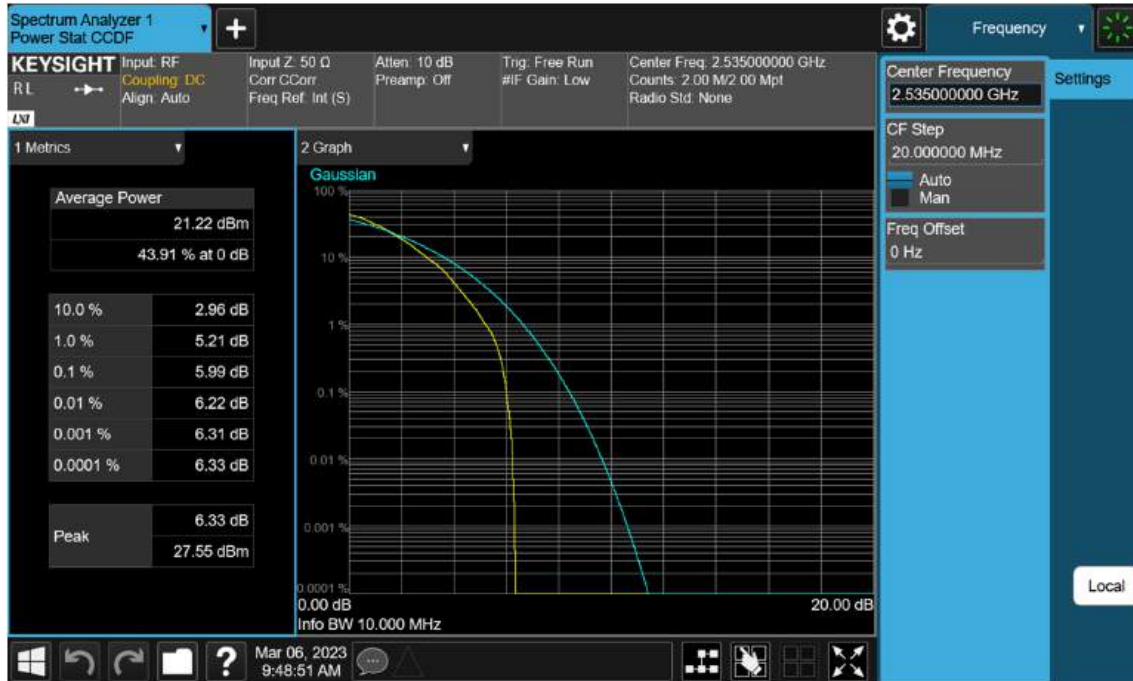
Sub6 n7. PAR Plot (10 M BW_Ch.507000_64QAM)
