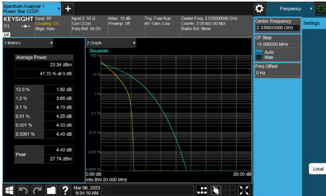
Sub6 n7. PAR Plot (20 M BW_Ch.507000_ BPSK)
