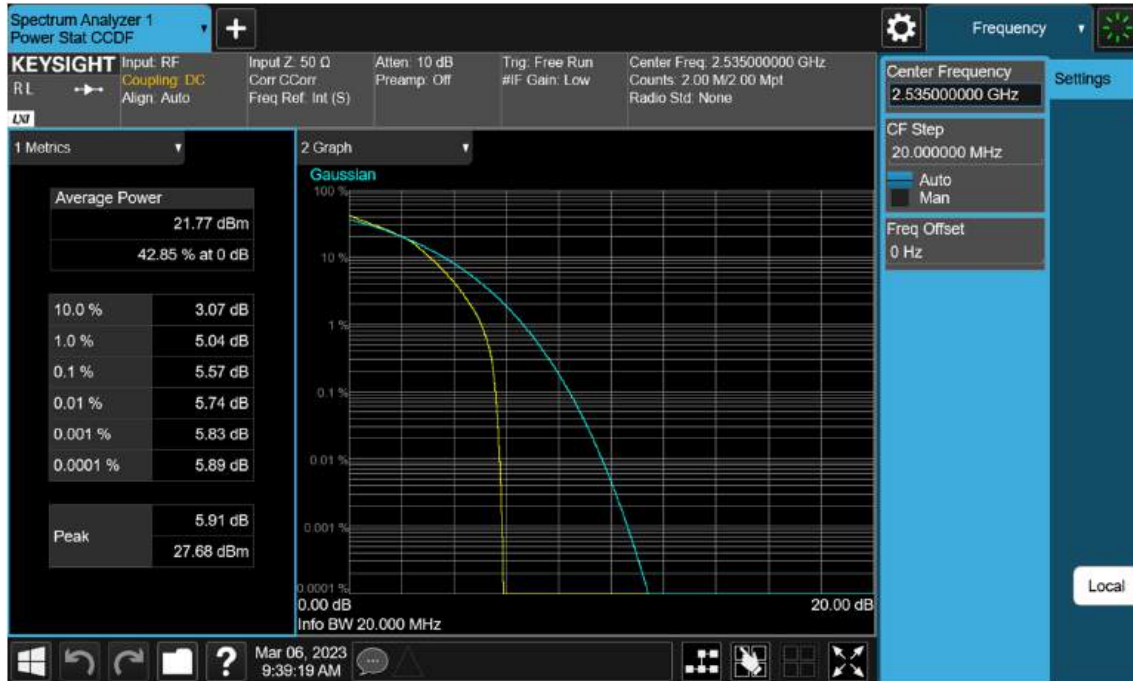
Sub6 n7. PAR Plot (20 M BW_Ch.507000_16QAM)
