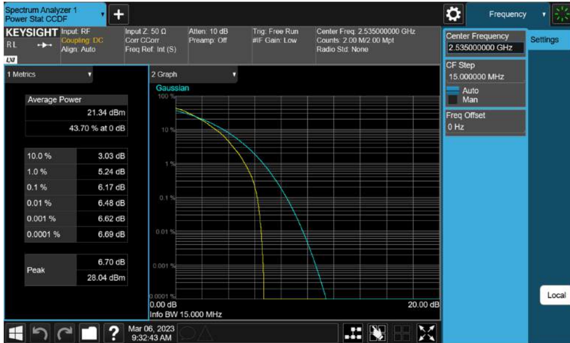
Sub6 n7. PAR Plot (15 M BW_Ch.507000_64QAM)
