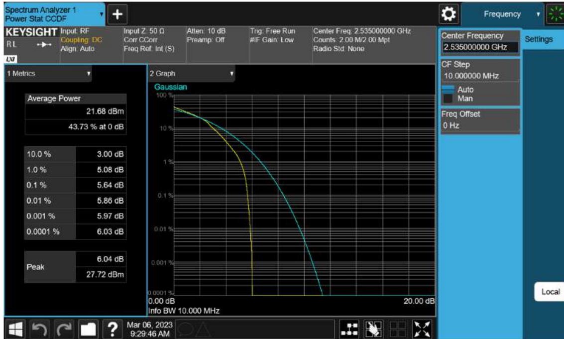
Sub6 n7. PAR Plot (10 M BW_Ch.507000_16QAM)
