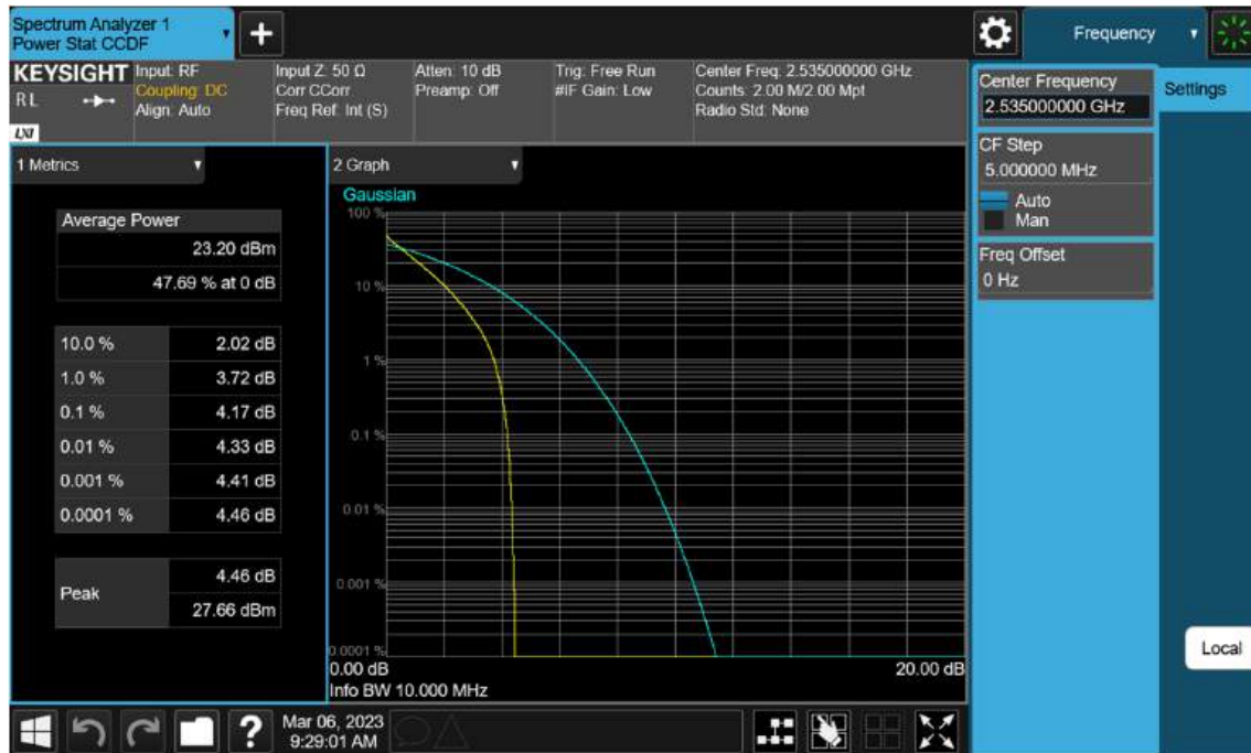
Sub6 n7. PAR Plot (10 M BW_Ch.507000_ BPSK)
