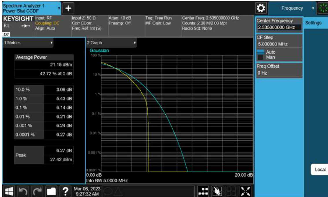
Sub6 n7. PAR Plot (5 M BW_Ch.507000_64QAM)
