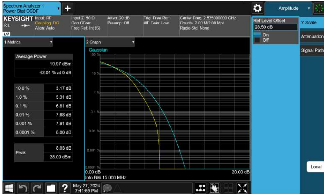
Sub6 n7. PAR Plot (15 M BW_Ch.507000_256QAM)
