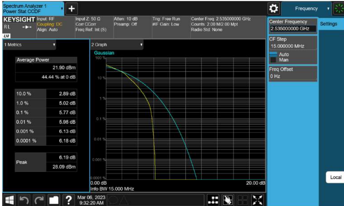
Sub6 n7. PAR Plot (15 M BW_Ch.507000_16QAM)
