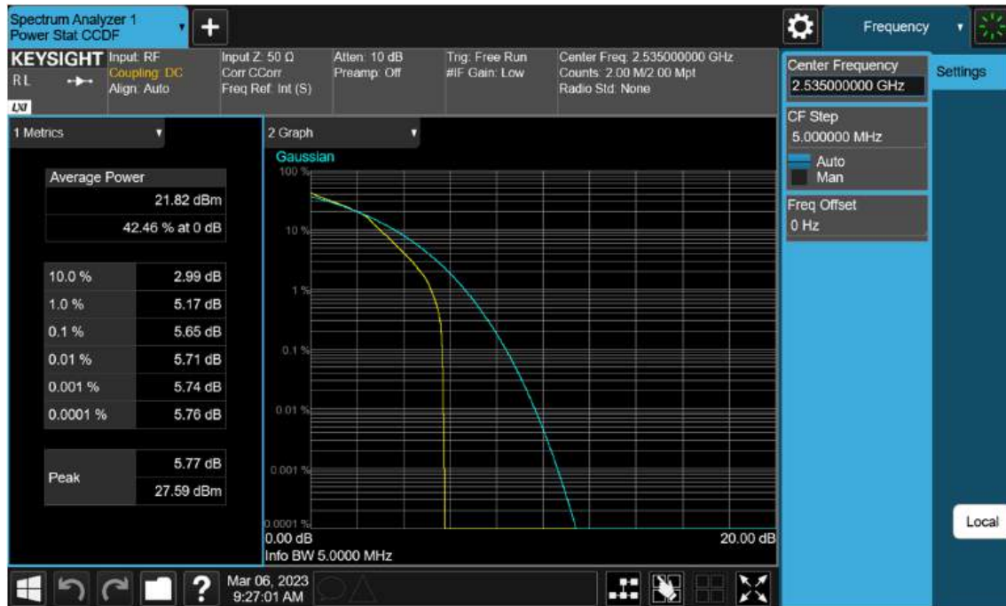
Sub6 n7. PAR Plot (5 M BW_Ch.507000_16QAM)
