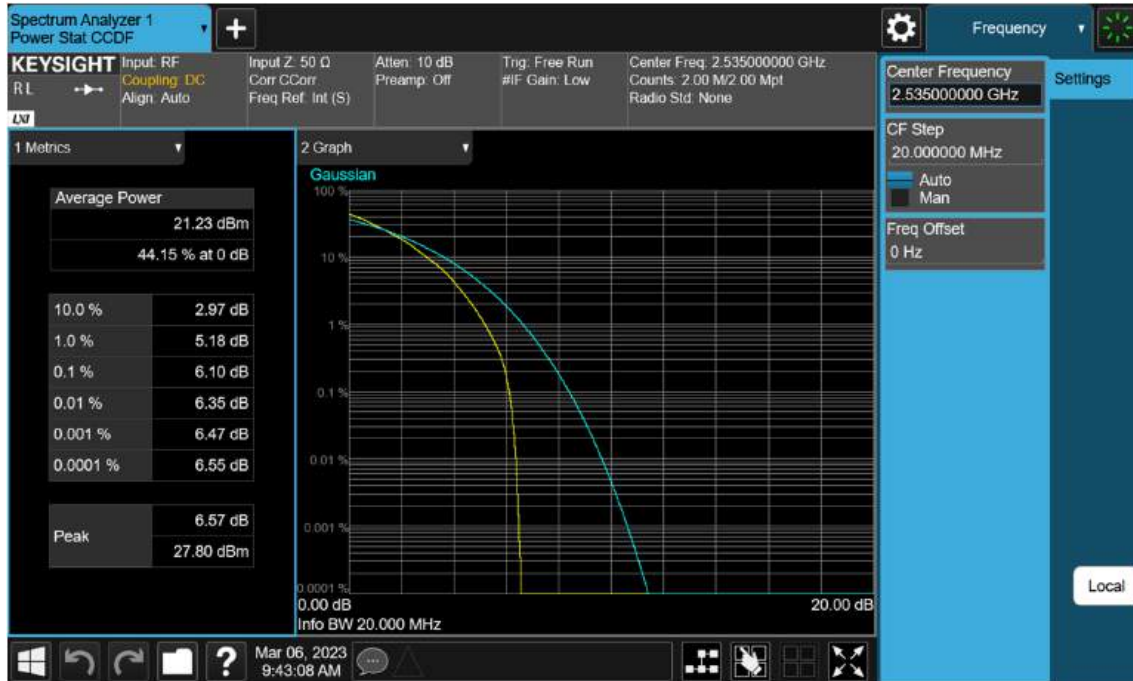
Sub6 n7. PAR Plot (20 M BW_Ch.507000_64QAM)
