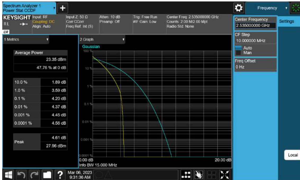
Sub6 n7. PAR Plot (15 M BW_Ch.507000_ BPSK)
