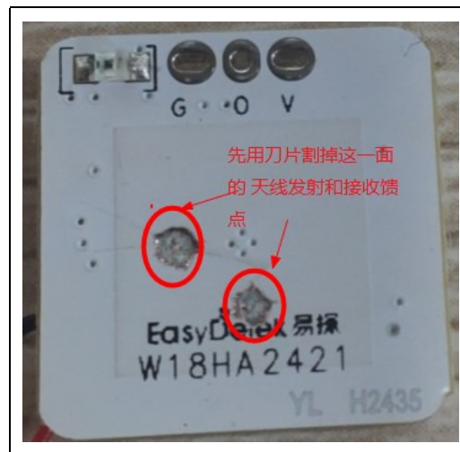
测试接收 和 发射的端口接线示意图 Test Receive and Transmit Port Wiring Diagrams:
