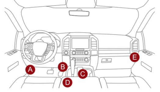
Habituellement, le port OBDII est sous le tableau de bord, au-dessus de la pédale du côté conducteur. Les cinq emplacements indiqués dans l'image sont des emplacements de port OBDII courants.
