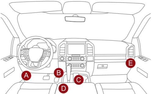
Por lo general, el puerto OBDII se encuentra debajo del tablero de instrumentos, un pedal en el lado del conductor. Las cinco ubicaciones que se muestran en la imagen son ubicaciones de puertos OBDII comunes.
