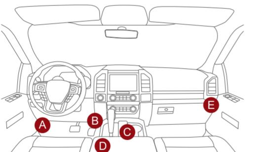
Normalerweise befindet sich der OBDII-Anschluss unter dem Armaturenbrett, über dem Pedal auf der Fahrerseite. Die fünf in der Abbildung gezeigten Positionen sind übliche OBDII-Portpositionen.
