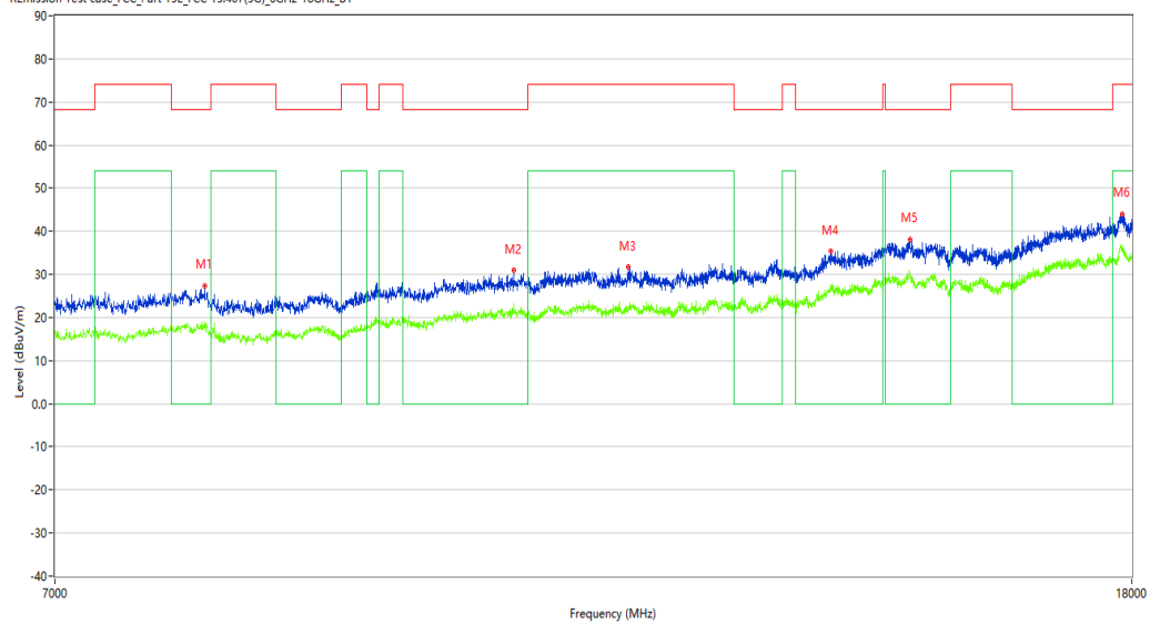
REmission Test case_FCC_Part 15E_FCC 15.407(5G)_6GHz-18GHz_B1
