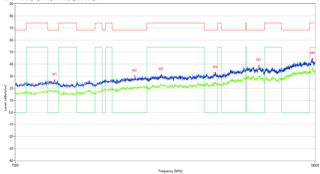
REmission Test case_FCC_Part 15E_FCC 15.407(5G)_6GHz-18GHz_B1
