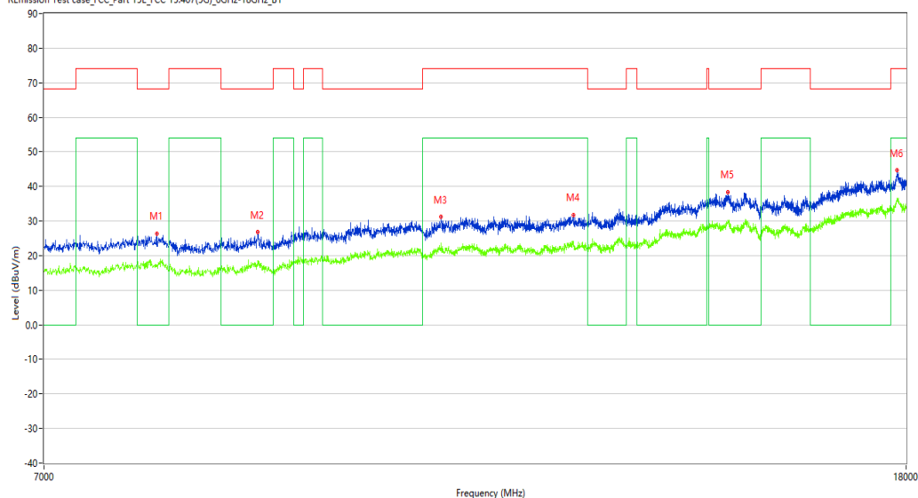
REmission Test case_FCC_Part 15E_FCC 15.407(5G)_6GHz-18GHz_B1
