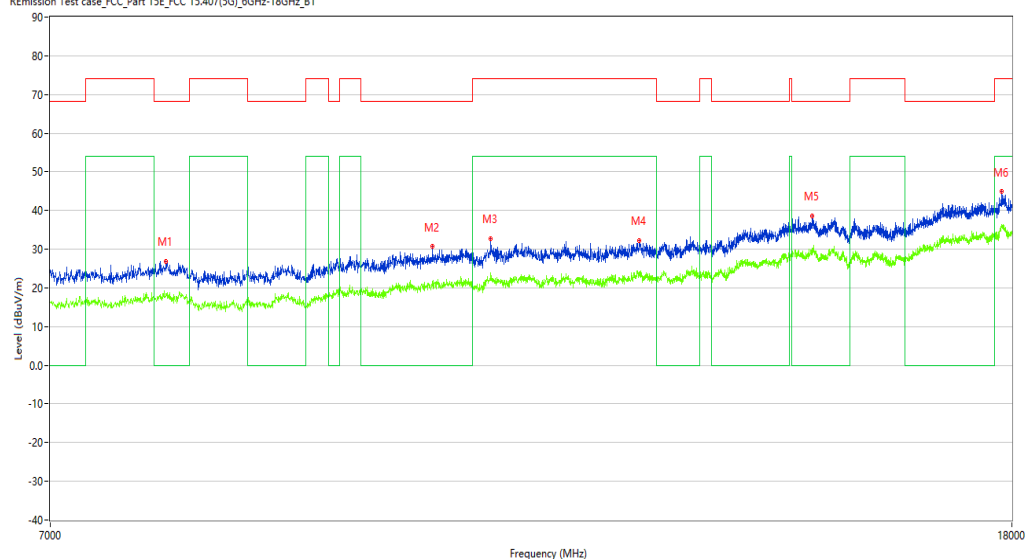
REmission Test case_FCC_Part 15E_FCC 15.407(5G)_6GHz-18GHz_B1
