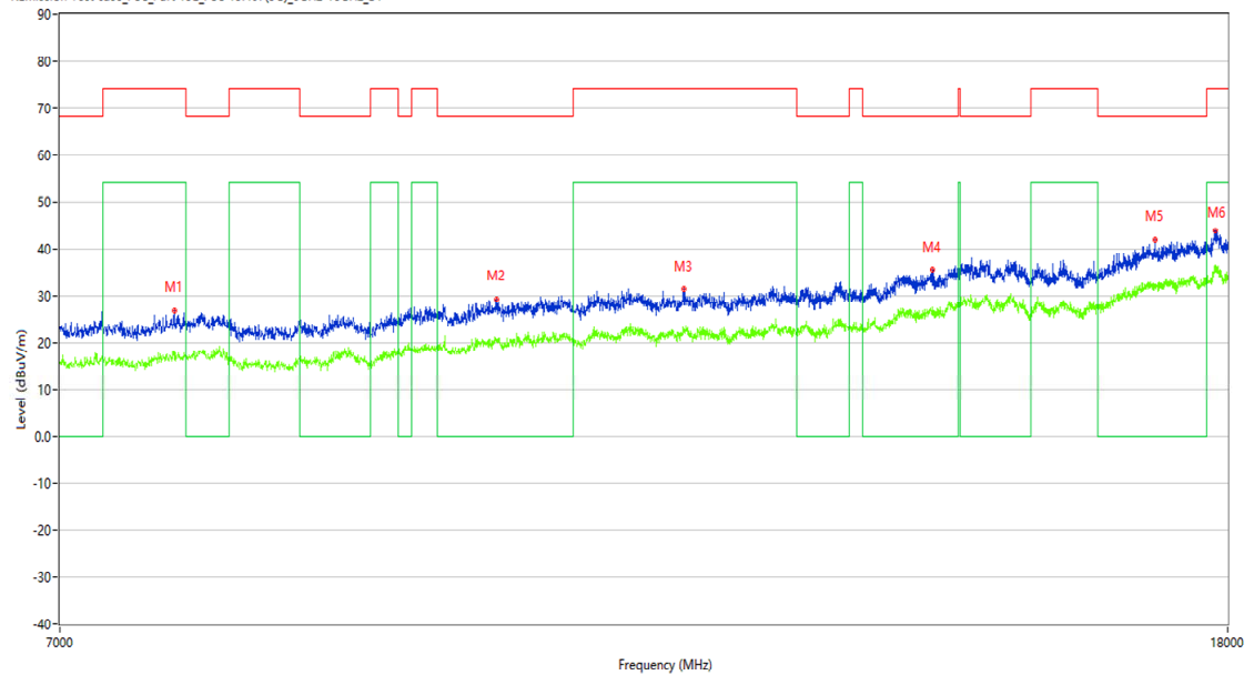
REmission Test case_FCC_Part 15E_FCC 15.407(5G)_6GHz-18GHz_B1
