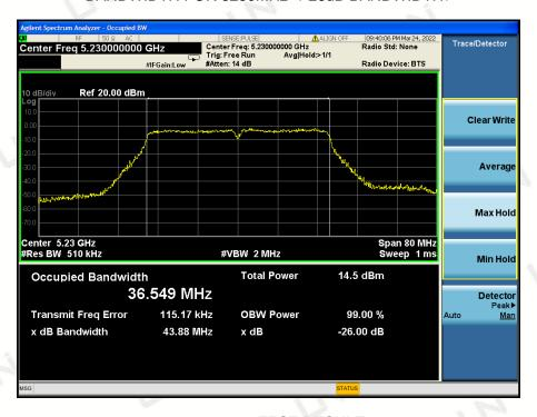
**802.11ac80 TEST RESULT**BANDWIDTH FOR 5210MHz(-26dB BANDWIDTH)
