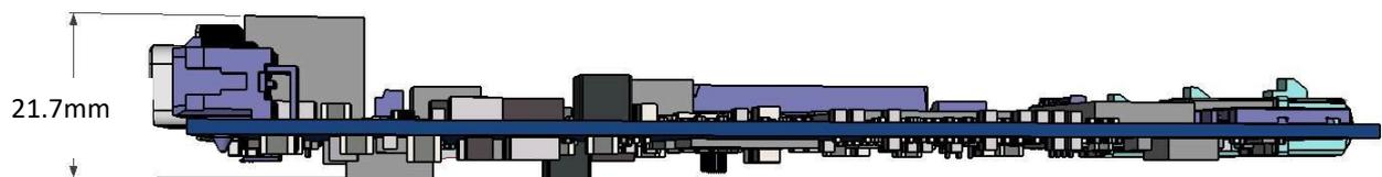
FIGURE 4 - SIDE VIEW WITH MAXIMUM CONNECTOR HEIGHTS
