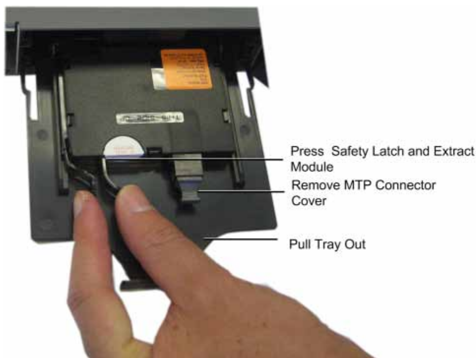
Figure 5-47. Extracting Edge Module
