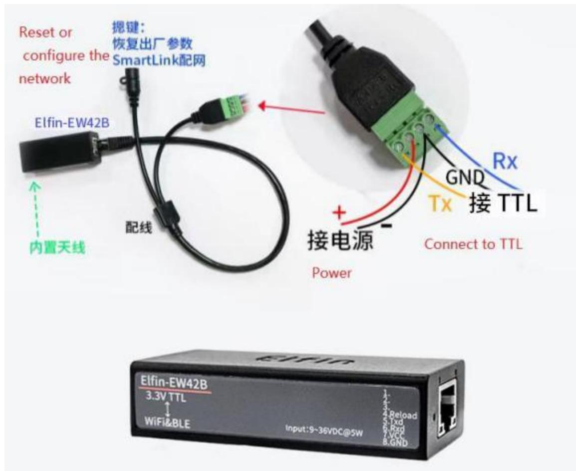
Figure 19. EW42B+RJ45 Conversion cable
