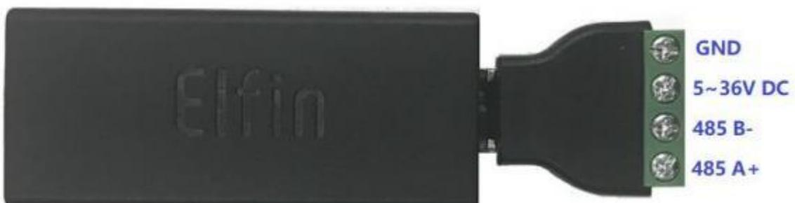
Figure 14. EW41B+4PIN Connector
