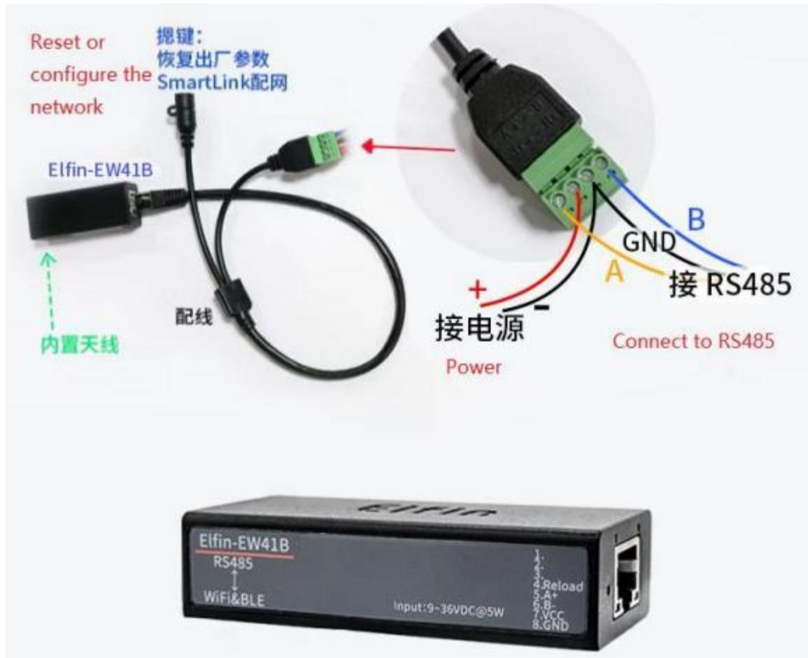
Figure 18. EW41B+RJ45 Conversion cable
