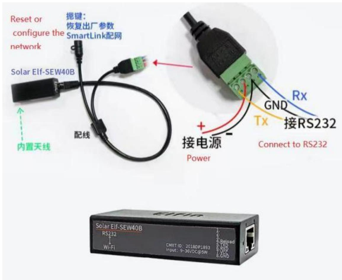
Figure 17. EW40B+RJ45 Conversion cable
