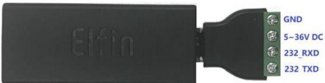
Figure 13. EW40B +4PIN Connector
