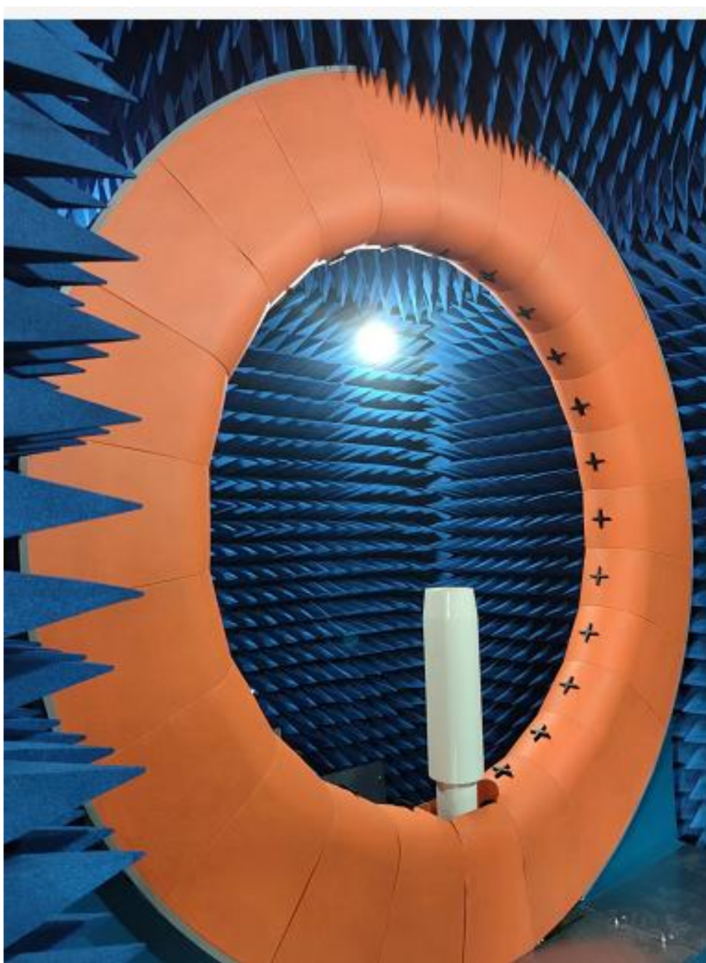
24 探头微波暗室测试设备
