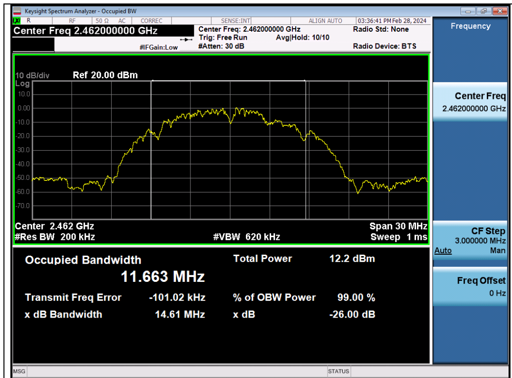
Test_Graph_802.11b_ANT1_2462_1Mbps_OBW
