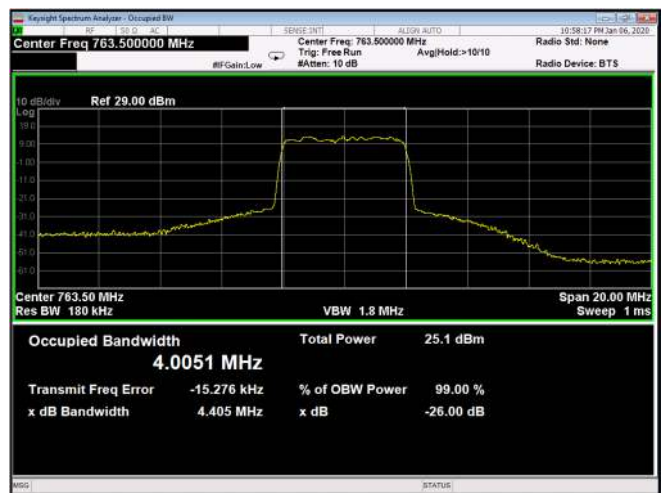
Figure 176: 64QAM 5MHz B.W.; 763.5MHz, 30kHz Output
