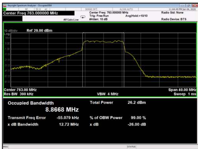
Figure 211: QPSK 10MHz B.W.; 763.0MHz, 30kHz Output
