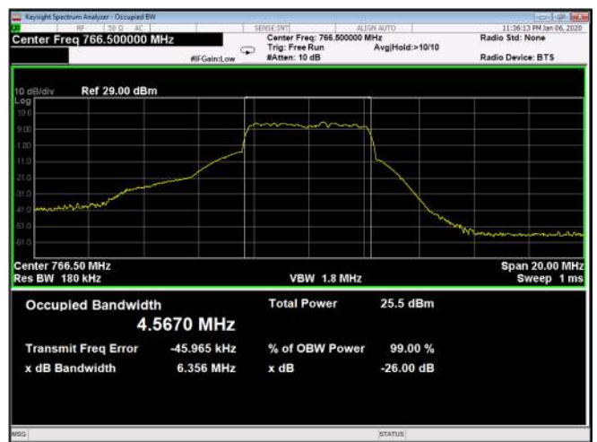
Figure 204: QPSK 5MHz B.W.; 766.5MHz, 15kHz Output
