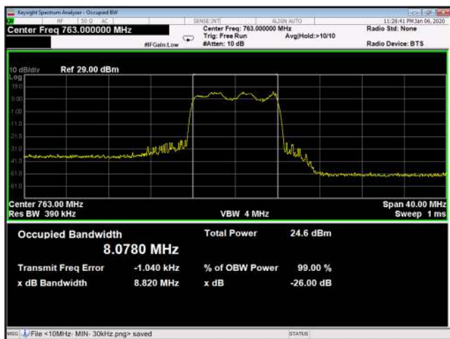
Figure 169: 16QAM 10MHz B.W.; 763.0MHz, 60kHz Output
