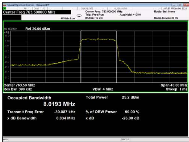
Figure 185: 64QAM 10MHz B.W.; 763.5MHz, 60kHz Output
