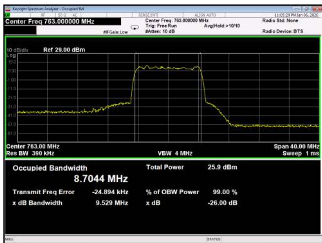
Figure 181: 64QAM 10MHz B.W.; 763.0MHz, 30kHz Output
