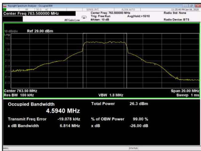
Figure 203: QPSK 5MHz B.W.; 763.5MHz, 15kHz Output
