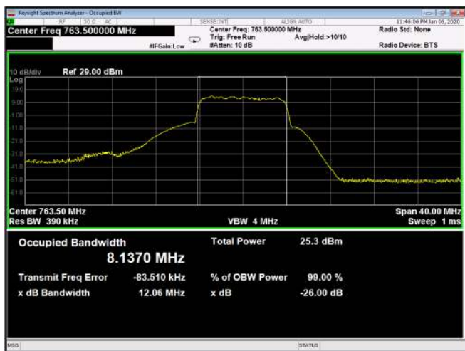
Figure 215: QPSK 10MHz B.W.; 763.5MHz, 60kHz Output
