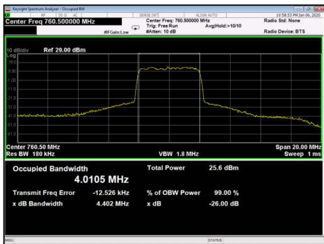
Figure 175: 64QAM 5MHz B.W.; 760.5MHz, 30kHz Output
