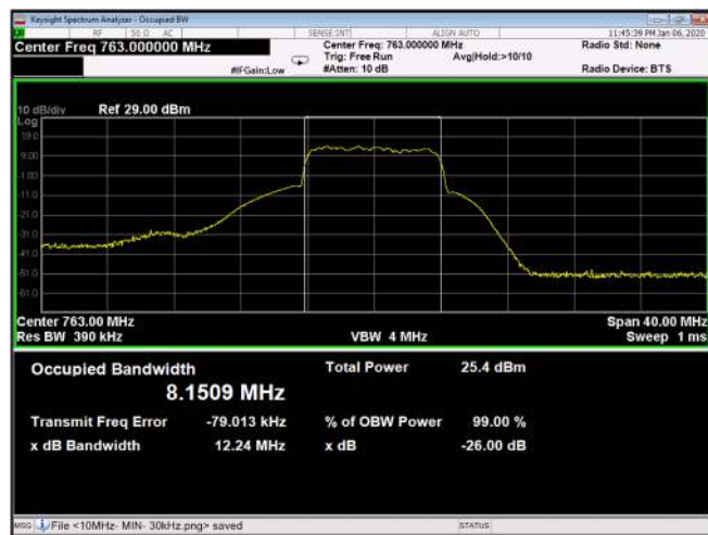
Figure 214: QPSK 10MHz B.W.; 763.0MHz, 60kHz Output
