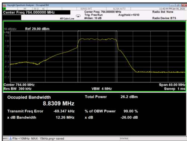
Figure 213: QPSK 10MHz B.W.; 764.0MHz, 30kHz Output
