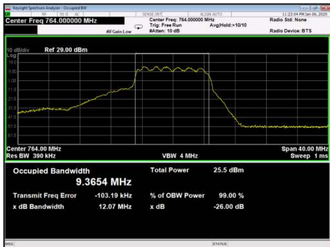
Figure 165: 16QAM 10MHz B.W.; 764.0MHz, 15kHz Output
