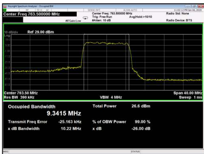
Figure 179: 64QAM 10MHz B.W.; 763.5MHz, 15kHz Output
