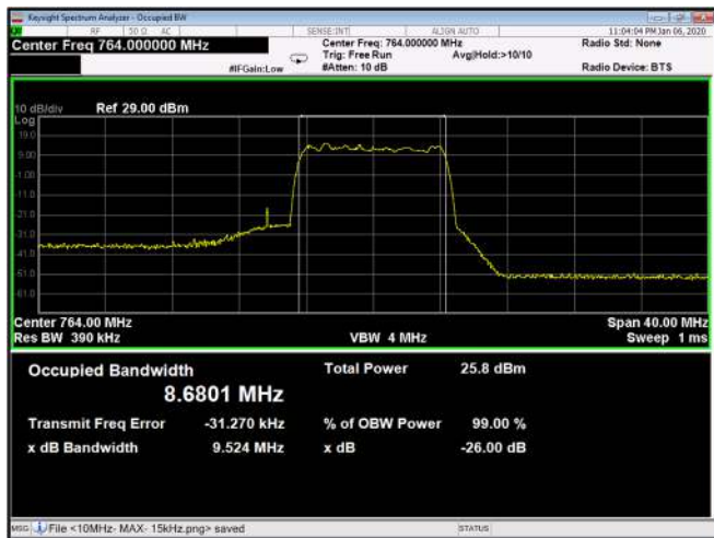
Figure 183: 64QAM 10MHz B.W.; 764.0MHz, 30kHz Output
