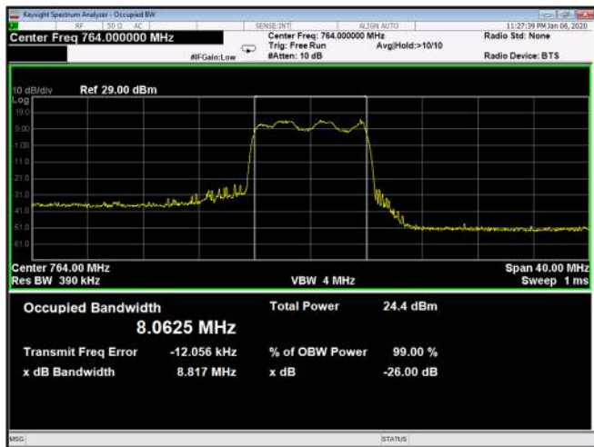
Figure 171: 16QAM 10MHz B.W.; 764.0MHz, 60kHz Output
