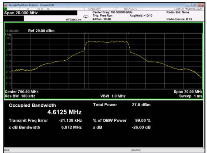
Figure 202: QPSK 5MHz B.W.; 760.5MHz, 15kHz Output
