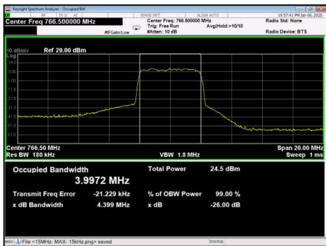
Figure 177: 64QAM 5MHz B.W.; 766.5MHz, 30kHz Output
