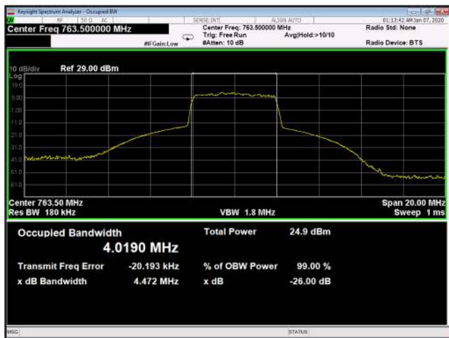
Figure 191: 256QAM 5MHz B.W.; 763.5MHz, 30kHz Output
