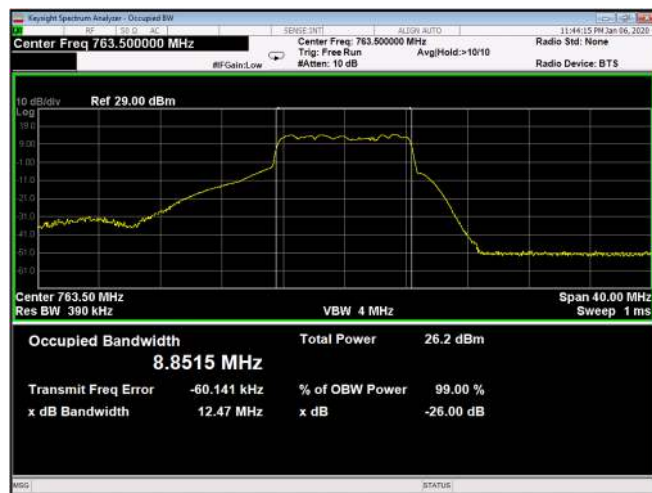
Figure 212: QPSK 10MHz B.W.; 763.5MHz, 30kHz Output
