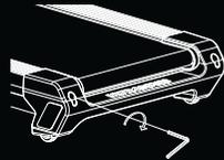
如果跑带右移, 则顺时针旋转右侧螺栓 ¼ 圈, 然后逆时针旋转左侧螺栓 ¼ 圈。如果跑带没有移动, 重复操作直至其居中。
