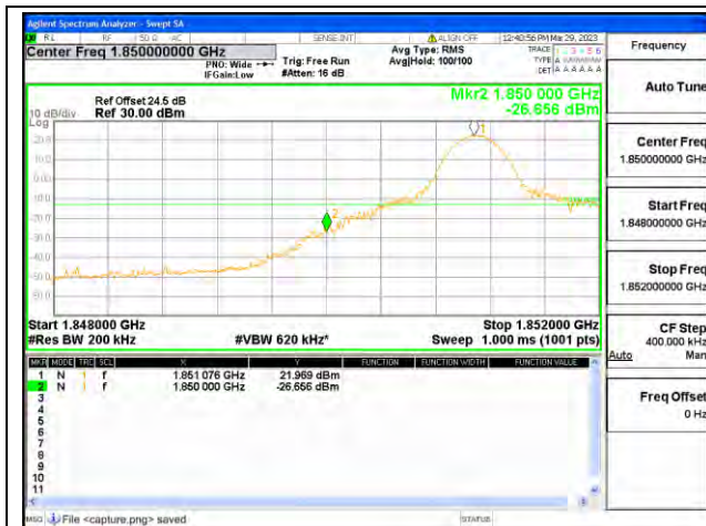
Band2 / 20MHz / Low CH / QPSK / 1 RB
