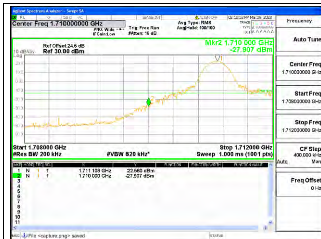
Band66 / 20MHz / Low CH / QPSK / 1 RB
