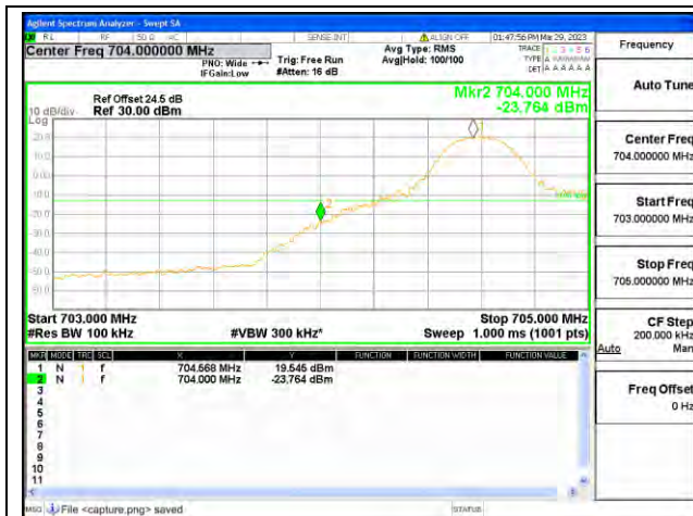
Band17 / 10MHz / Low CH / QPSK / 1 RB
