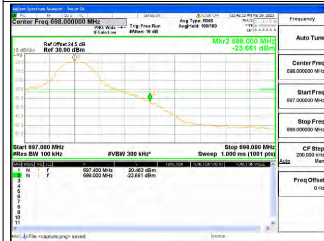
Band71 / 10MHz / High CH / QPSK / 1 RB
