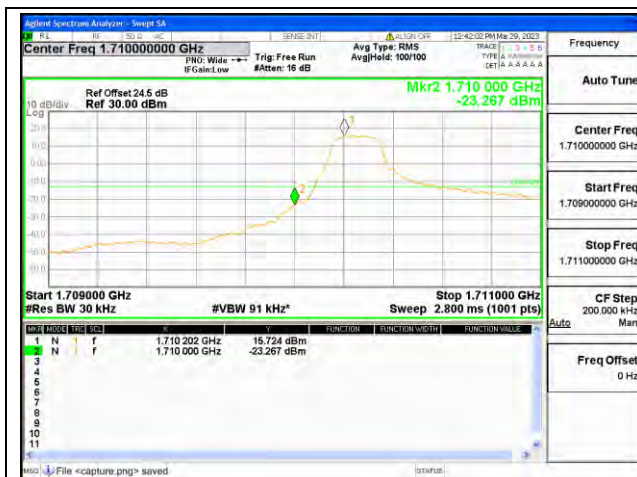
Band4 / 1.4MHz / Low CH / QPSK / 1 RB
