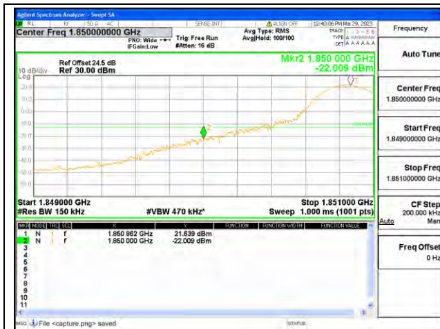
Band2 / 15MHz / Low CH / QPSK / 1 RB
