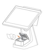
向上拉打印机把手,纸仓盖 自动弹出。
