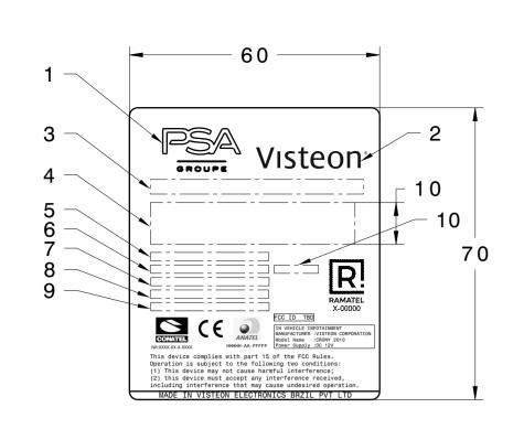
PRINTING FROM LABEL SUPPLIER GAP BETWEEN LINE IS 2.0mm. LETTER HEIGHT IS 2.0mm
