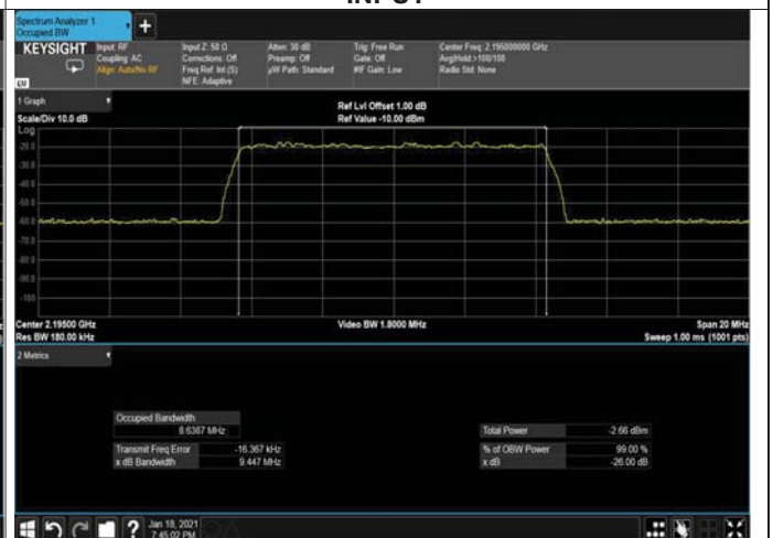
Figure 206: 64QAM 10MHz B.W; 2195.0MHz, 30kHz INPUT
