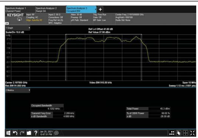
Figure 308: QPSK 5MHz B.W; 2197.5MHz, 30kHz OUTPUT
