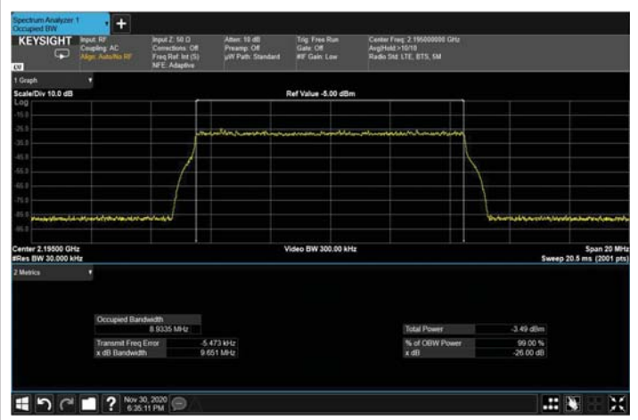
Figure 347: QPSK 10MHz; 2195MHz – 4G INPUT
