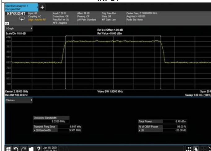
Figure 205: 64QAM 10MHz B.W; 2195.0MHz, 15kHz INPUT
