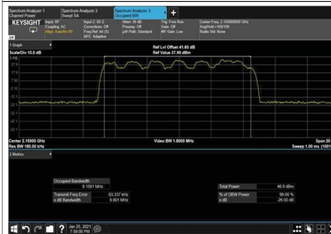
Figure 311: QPSK 10MHz B.W; 2155MHz, 15kHz OUTPUT
