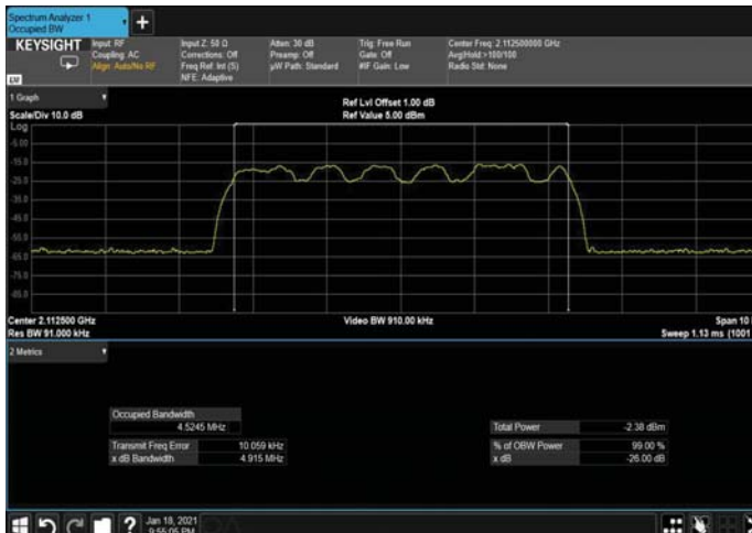
Figure 231: QPSK 5MHz B.W; 2112.5MHz, 15kHz INPUT
