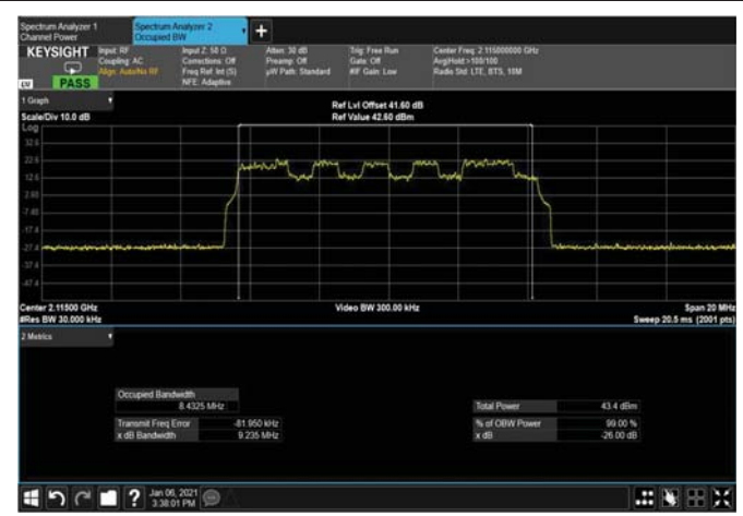
Figure 310: QPSK 10MHz B.W; 2115MHz, 30kHz OUTPUT
