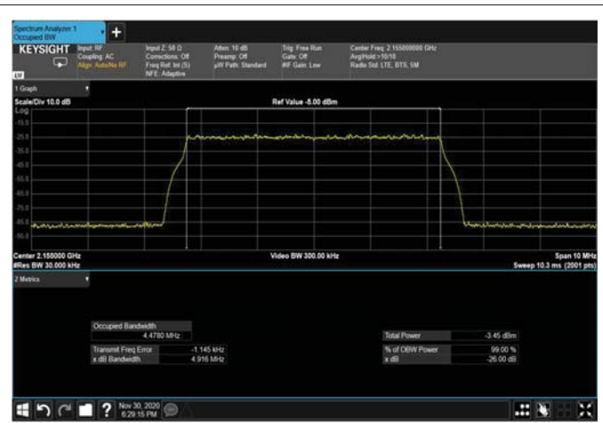
Figure 343: QPSK 5MHz B.W; 2155MHz – 4G INPUT
