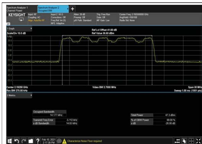
Figure 319: QPSK 15MHz B.W; 2192.5MHz, 15kHz OUTPUT
