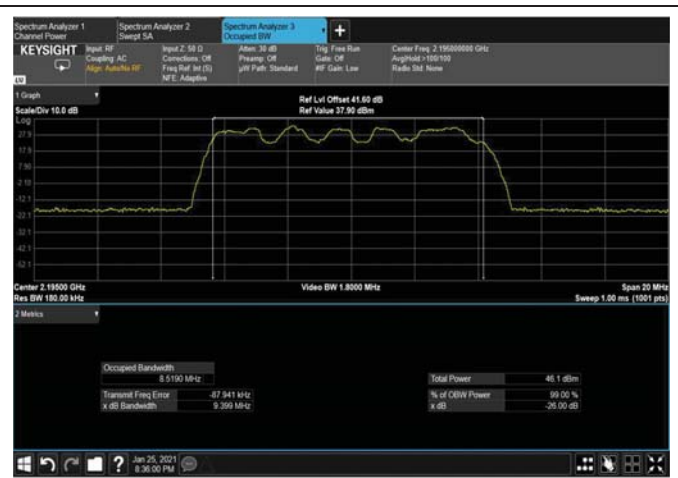
Figure 314: QPSK 10MHz B.W; 2195MHz, 30kHz OUTPUT
