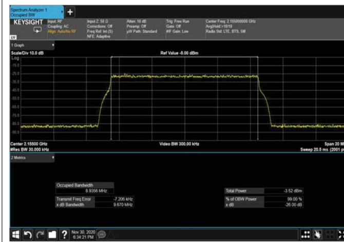
Figure 346: QPSK 10MHz; 2155MHz – 4G INPUT
