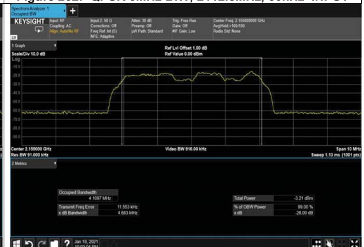
Figure 234: QPSK 5MHz B.W; 2155.0MHz, 30kHz INPUT
