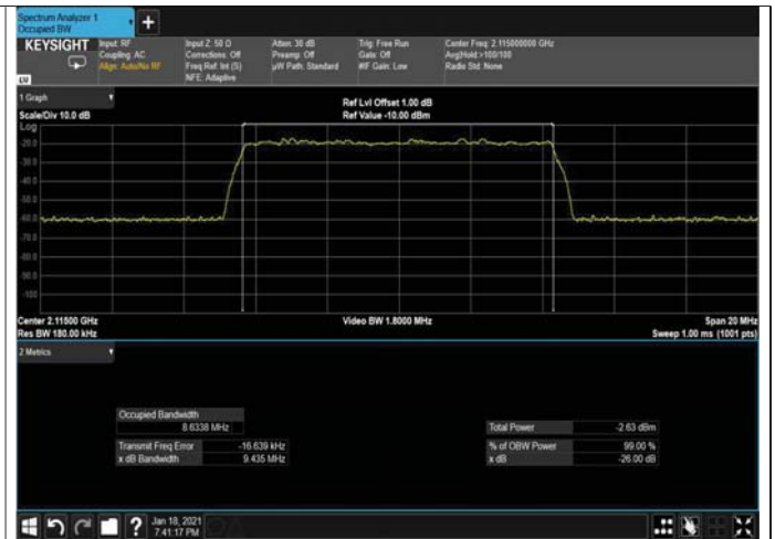
Figure 202: 64QAM 10MHz B.W; 2115.0MHz, 30kHz INPUT
