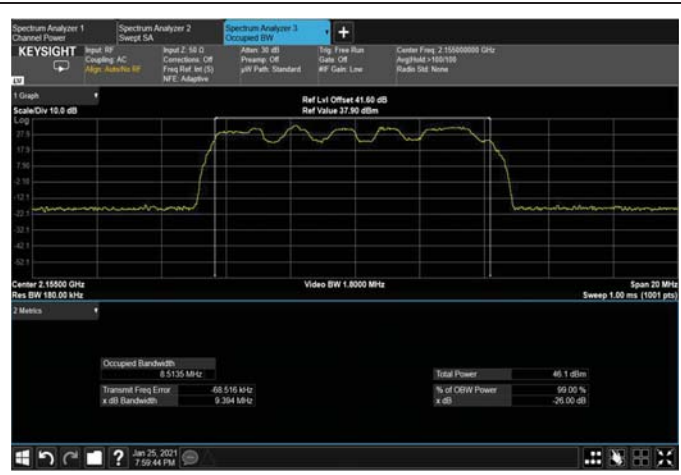
Figure 312: QPSK 10MHz B.W; 2155MHz, 30kHz OUTPUT
