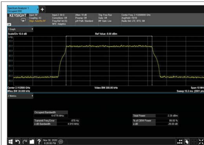
Figure 342: QPSK 5MHz B.W; 2112.5MHz – 4G INPUT
