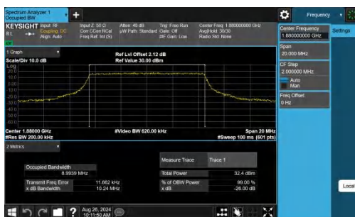
Band2-10MHz-QPSK-18900-50RB#0-PASS
