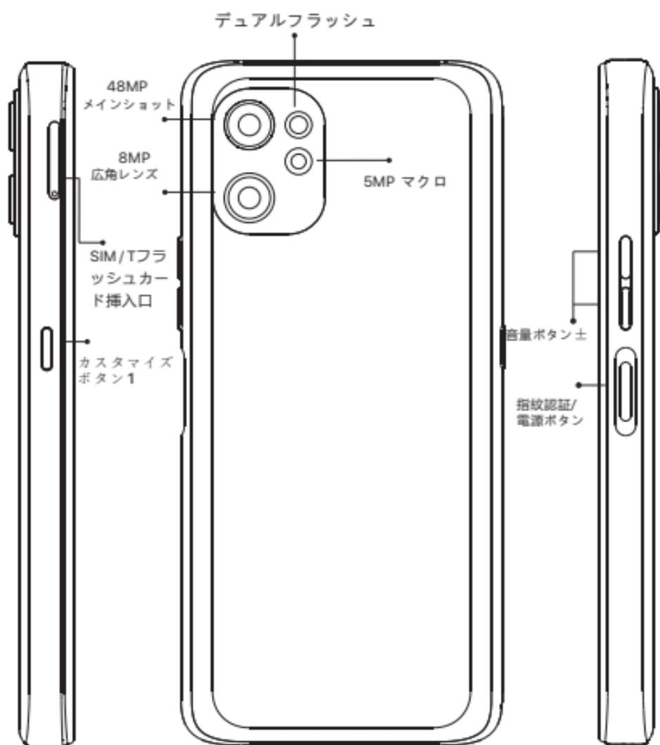
音量キー:短く押すと音量を調節または着信をミュートします。
