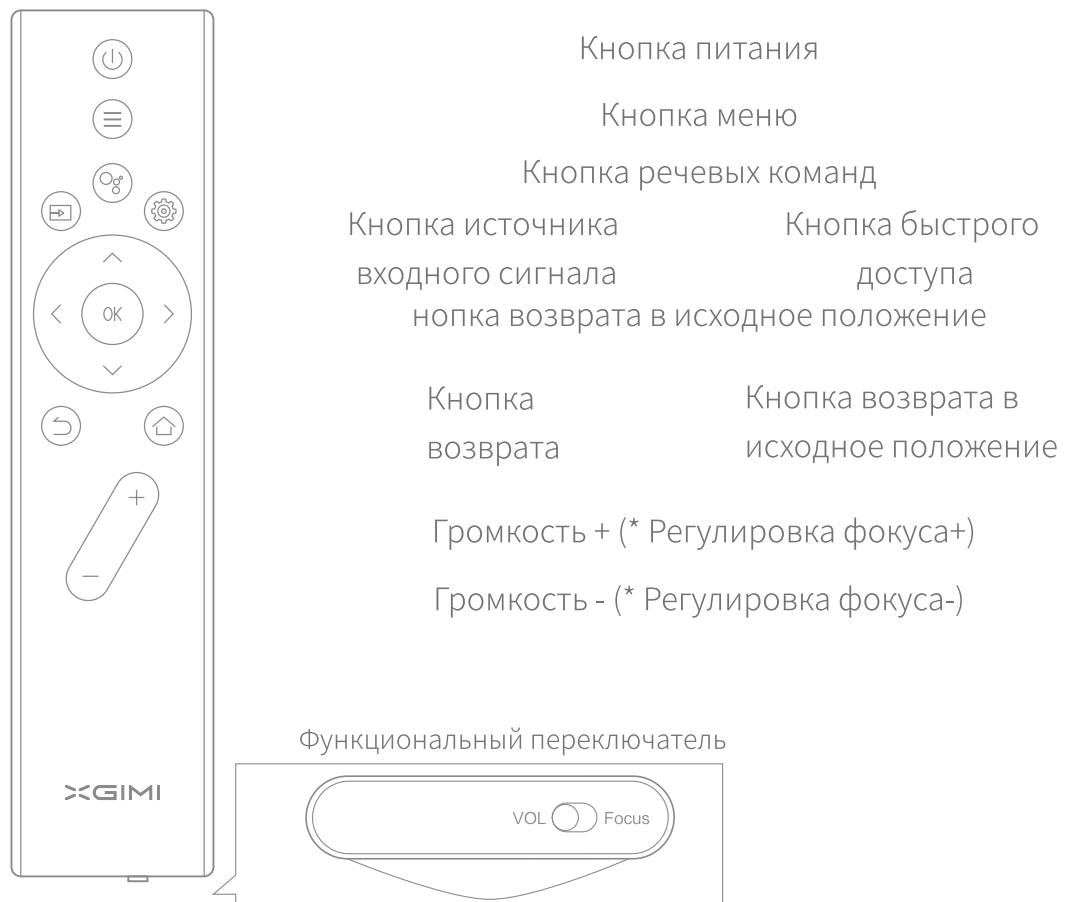
\*Громкость регулируется с помощью коавиши +/- при перемещении функционального переключателя влево (VOL).
