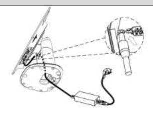
适配器电源插头穿过支架底部过线孔,然后将电源插头插入上板接口,再接
