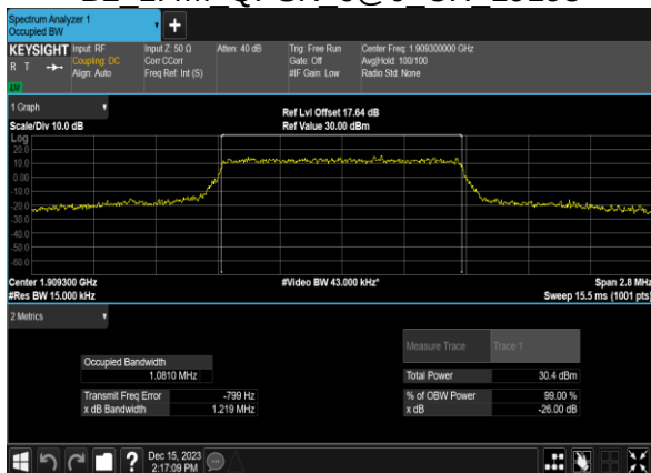
B2 1.4M QPSK 6@0 CH 19193
