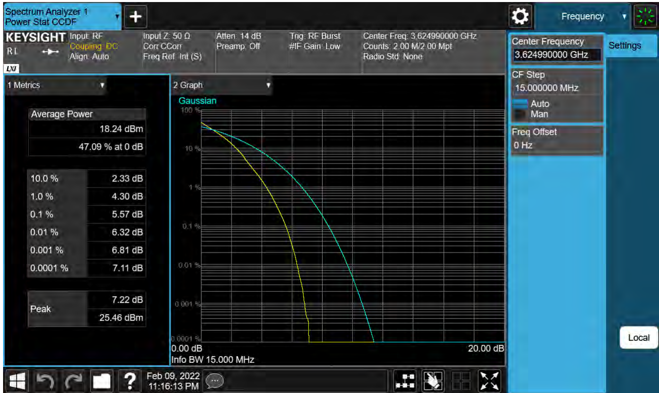
Sub6 n48. PAR Plot (15 MHz Ch. 641666 QPSK)
