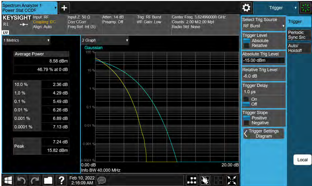
Sub6 n48. PAR Plot (40 MHz Ch. 641666 QPSK)
