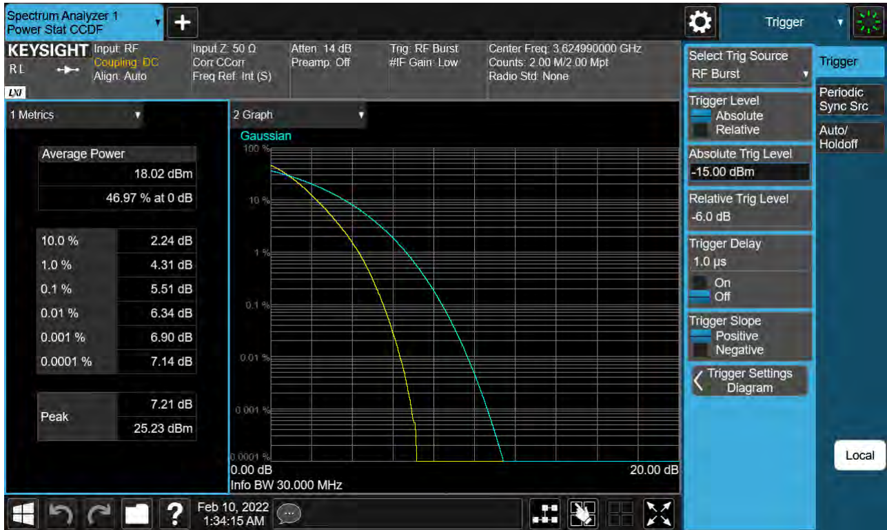
Sub6 n48. PAR Plot (30 MHz Ch. 641666 QPSK)
