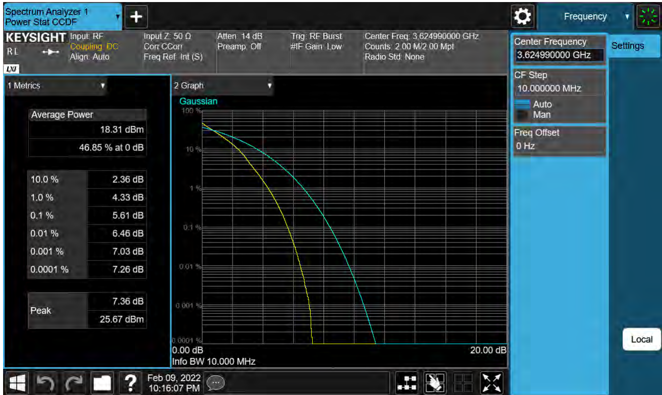
Sub6 n48. PAR Plot (10 MHz Ch. 641666 QPSK)
