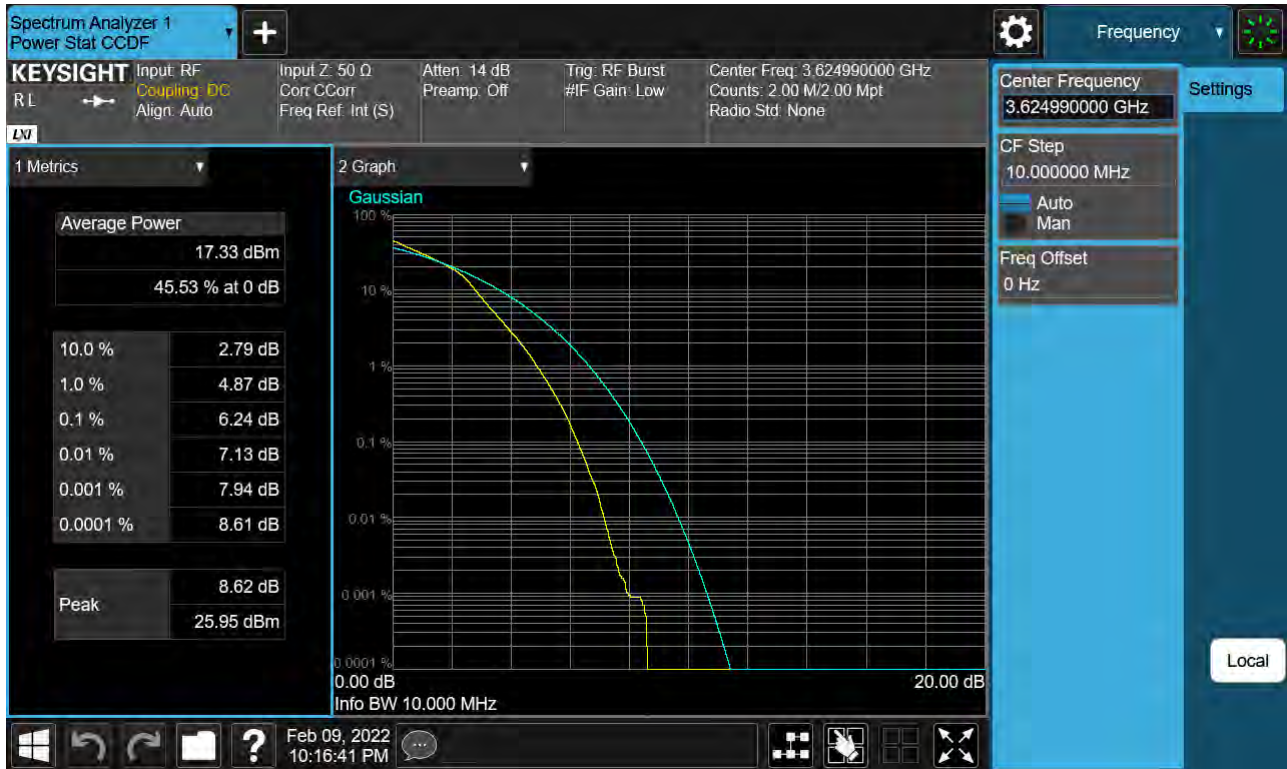
Sub6 n48. PAR Plot (10 MHz Ch.641666 16-QAM)
