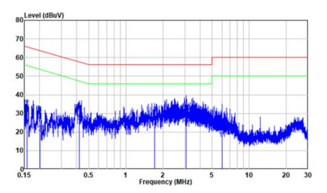
Site : Shielding Room Condition: Line Mode : TX Model : CS5229 Power : AC 120V 60Hz Adapter : S003AKU0600040
