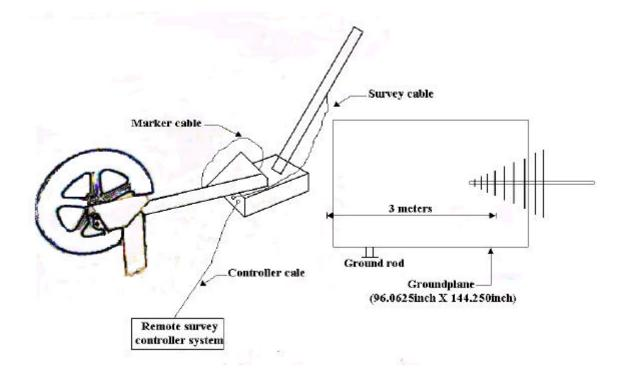
FIGURE 1.3-1 TEST SETUP BLOCK DIAGRAM (M/N 3101D)
